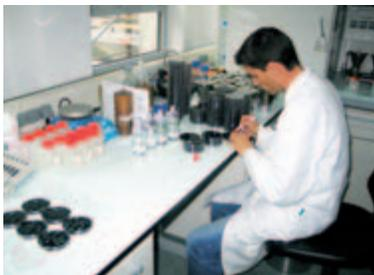
► Zur Testung auf ein Bakterium – hier Legionellen – wird die Filterprobe auf einem spezifischen Nährboden in einer Petrischale bebrütet.
