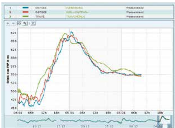
Pegelganglinie der Hochwassersituation (4./5.01.2017)
