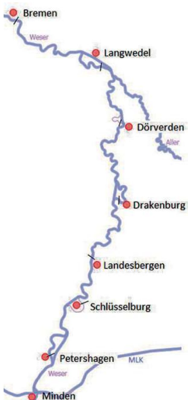
Siebenteilige Staustufenkette der Mittelweser
