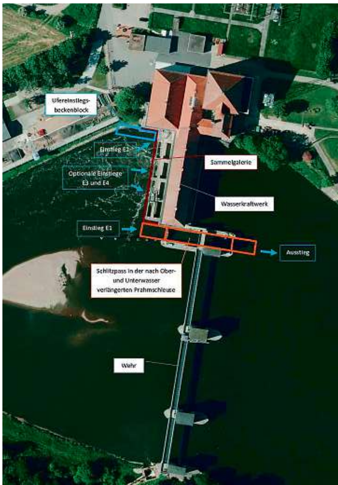
Schematische Darstellung der Fischaufstiegsanlage Dörverden
