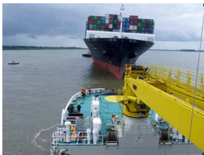
Die Schleppverbindung wird hergestellt.
