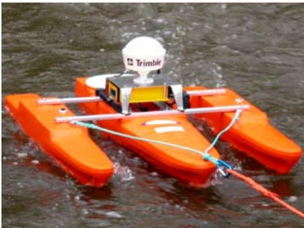
Trimaran für mobile Durchflussmessungen von Brücken usw.
