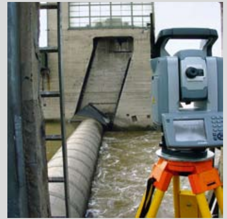
Abstandsmessungen mittels elektro-optischer Totalstation
