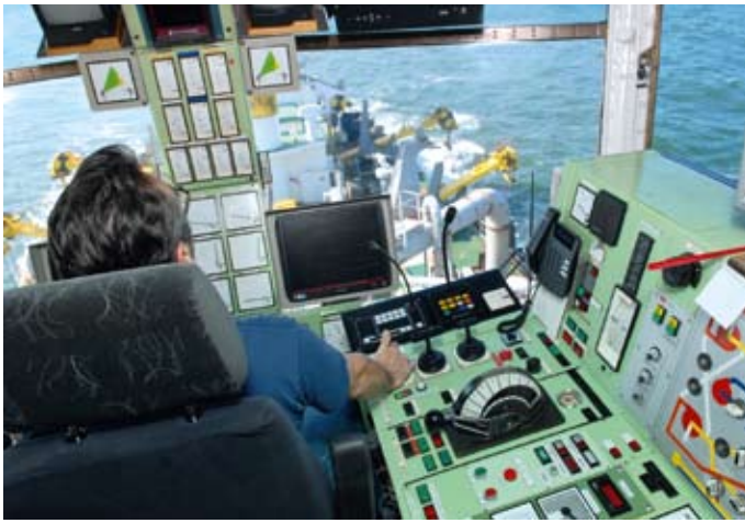
Echte Präzisionsarbeit – Von der Brücke aus wird jede Aktion des Saugbaggers gesteuert
