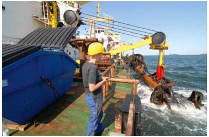
„Nordsee“ bei der Arbeit auf der Jade – Ein Saugrohr wird ins Wasser gelassen
