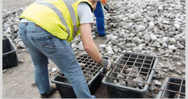
Baustoffprüfung der Wasserbausteine
