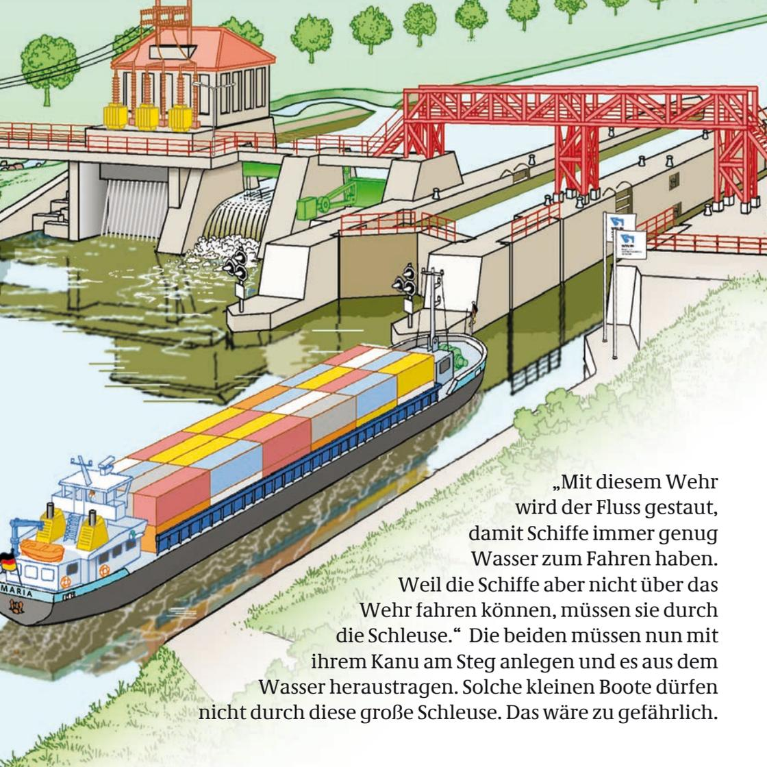
„Mit diesem Wehr wird der Fluss gestaut, damit Schiffe immer genug Wasser zum Fahren haben.
