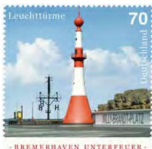
Das Bremerhavener Unterfeuer dient seit 1893 als Richtfeuer. Die erzeugte Richtfeuerlinie bezeichnet die Fahrrinne im Blexer Bogen, den Übergangsbereich von Außen- und Unterweser.
