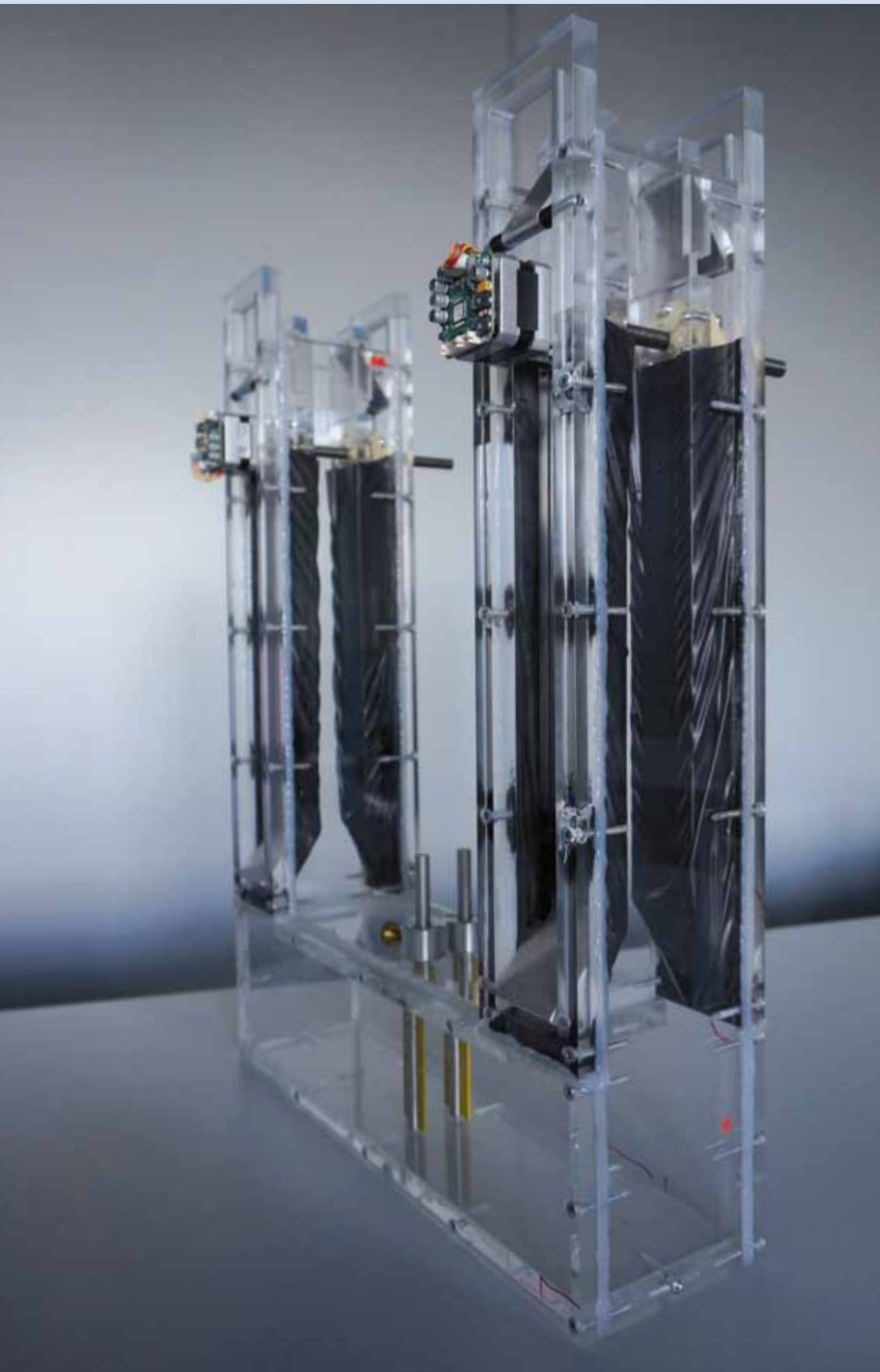
Bild 1: Prototyp des semi-aktiven Flüssigkeitssäulendämpfers zur Reduktion wind- und erdbebeninduzierter Bauwerksschwingungen. Foto: Lehrstuhl für Baustatik und Baudynamik
