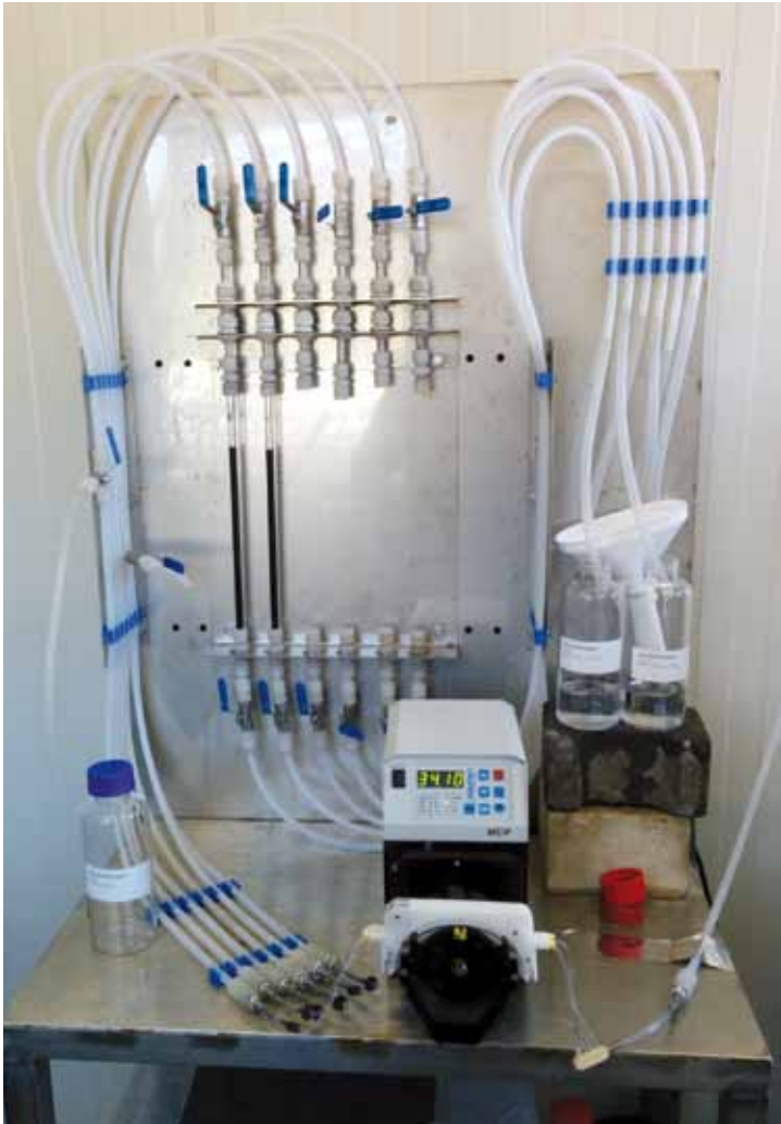
Bild 3 und Bild 4: Einsatz von Aktivkohle zur Elimination von Arzneimittelrückständen – vom Labormaßstab (rechts) bis hin zur großtechnischen Umsetzung auf Kläranlagen (links). Quelle: ISA
