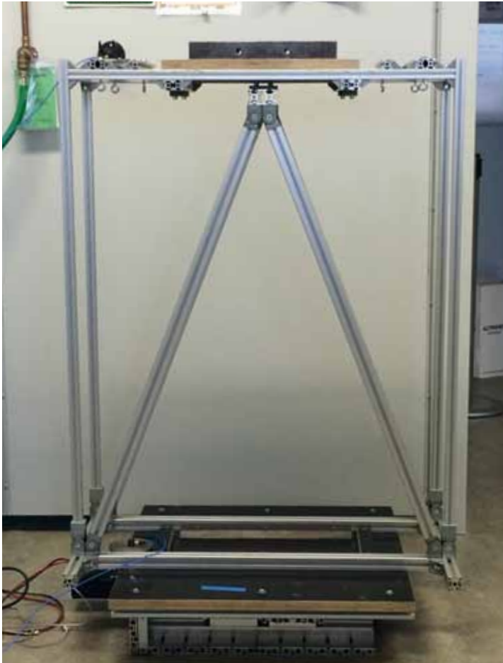
Bild 2: Schwingtischuntersuchungen an Modellkonstruktionen – Entwicklung eines neuartigen Dämpfers aus Formgedächtnislegierungen.
