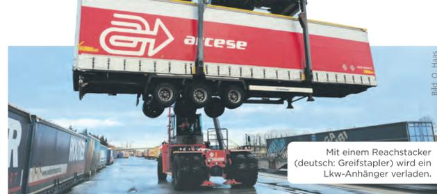
Mit einem Reachstacker (deutsch: Greifstapler) wird ein Lkw-Anhänger verladen.
