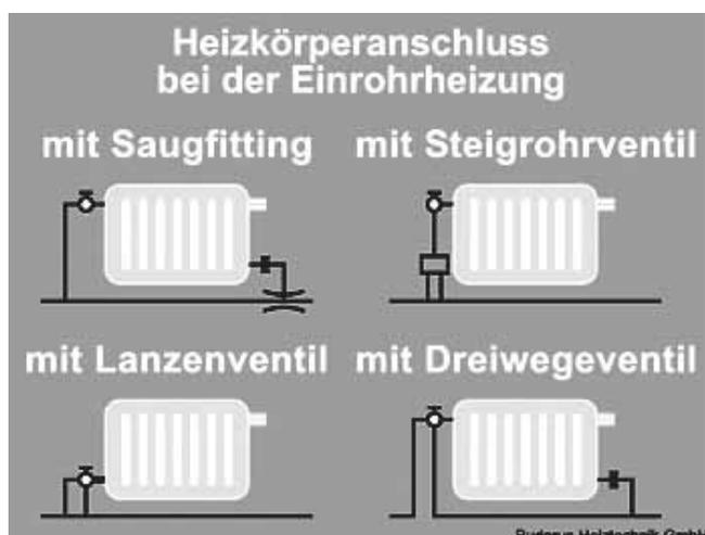
Integrationsmöglichkeiten von Heizkörpern in das System der Einrohrheizung.
