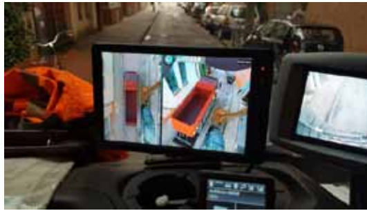
Abbildung 2: Monitor des Birdviewsystems im Fahrerhaus
