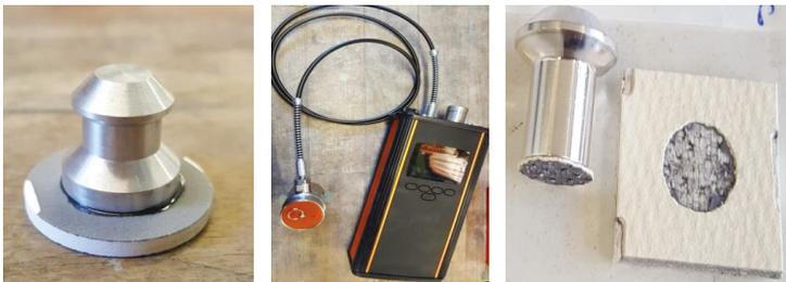
Abbildung 28: Haftzugprobe mit Stempel (links), PAT-Testgerät (mitte), Probe nach erfolgtem Haftzugversuch mit Adhäsionsversagen (rechts).
