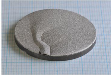
**Abb. 5.20** Delamination der Schicht von Probe D1, wodurch keine weiteren sinnvolle Untersuchungen möglich waren.
