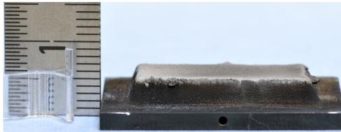
**Abb. 4.26** Einkristallines Substrat mit einer dicken Reparaturschicht von mehr als 3 mm. Verwendet für Indentationsmessungen.
