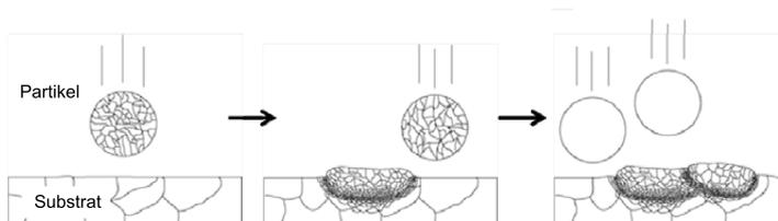
**Abb. 2.16** Schematische Zeichnung der Entstehung der nanokristallinen Kornstruktur beim Schichtaufbau [76].
