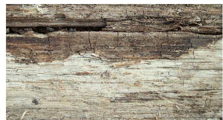
Braunfäule oben verfärbt das Holz braun, da sie das Lignin nicht angreift, während Weißfäule durch den Abbau des Lignins eine weiße Verfärbung bedingt.
