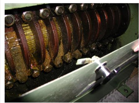
Blick in eine geöffnete Seiherstab-Schneckenpresse. Das gepresste Öl tritt zwischen den Seiherstäben aus.
