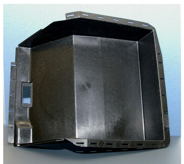
Handschuhfach aus hanffaserverstärktem Kunststoff in einer Matrix aus Polypropylen (PP), hergestellt im NF-Spritzgussverfahren (Möller Tech).
