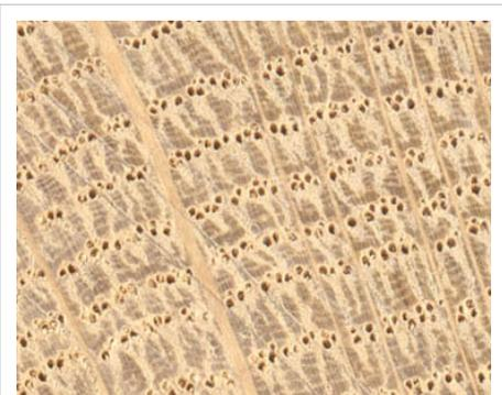
Eichenholz (*Quercus robur*), mit Porenreihen (Querschnitt)
