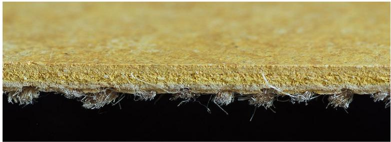
Querschnitt eines Linoleumstücks; die gleichmäßige Mischung ist an der Farbstoffdurchdringung bis zum Trägermaterial erkennbar
