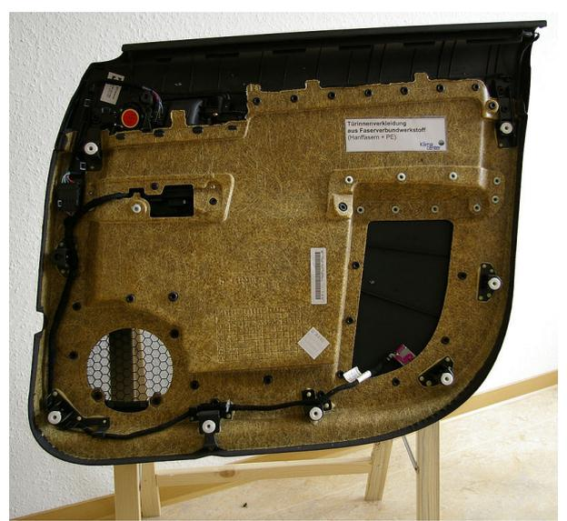
Türinnenverkleidung aus hanffaserverstärktem Kunststoff (Matrix Polyethylen PE)
