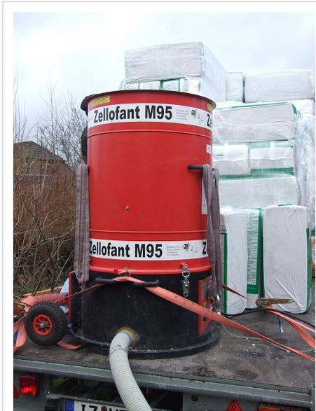
Zelluloseflocken werden über den Dosierer (Tonne) eingebracht und durch den Schlauch in Hohlräume eingeblasen.
