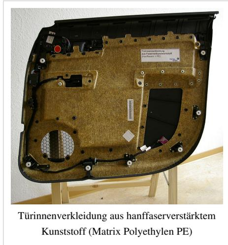
Türinnenverkleidung aus hanffaserverstärktem Kunststoff (Matrix Polyethylen PE)
