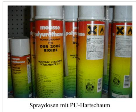
Herstellung erreichen Polyurethan-Schäume mit Kohlendioxid als Zellgas Wärmeleitfähigkeiten von ca. 0,029 bis 0,033  $\text{W}\cdot\text{m}^{-1}\cdot\text{K}^{-1}$ , Polyurethan-Schäume mit Cyclopentan als Zellgas Wärmeleitfähigkeiten von ca. 0,022 bis 0,027  $\text{W}\cdot\text{m}^{-1}\cdot\text{K}^{-1}$ . Die Polyurethan-Schäume können sowohl hart als auch flexibel mit unterschiedlichen Dichten eingestellt werden.
