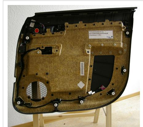
Türinnenverkleidung aus hanffaserverstärktem Kunststoff (Matrix Polyethylen PE)
