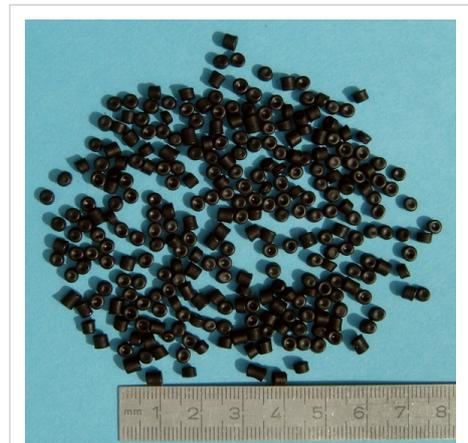
Granulat aus PE-LD mit Ruß als UV-Stabilisator
