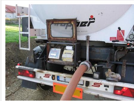
On-Board Wiegesystem eines Silofahrzeugs für Holzpellets
