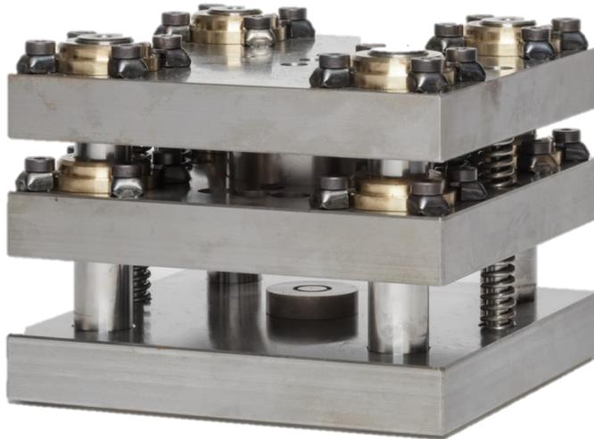
**Abbildung 25:** Foto der Tiefziehvorrichtung zur Herstellung von metallischen Flowfields (Copyright: Forschungszentrum Jülich GmbH)
