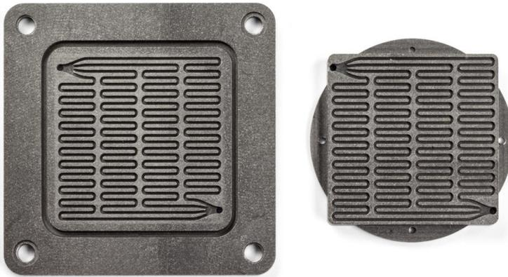
**Abbildung 19:** Verwendetes Flowfield für die Leistungsmessungen bezüglich des optimalen Anpressdrucks (Copyright: Forschungszentrum Jülich GmbH)
