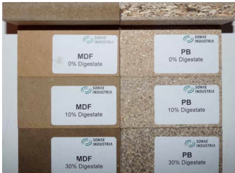
Abbildung 5: Laborversuche von MDF- und Spanplatten mit unterschiedlichen Anteilen von Gärprodukten
