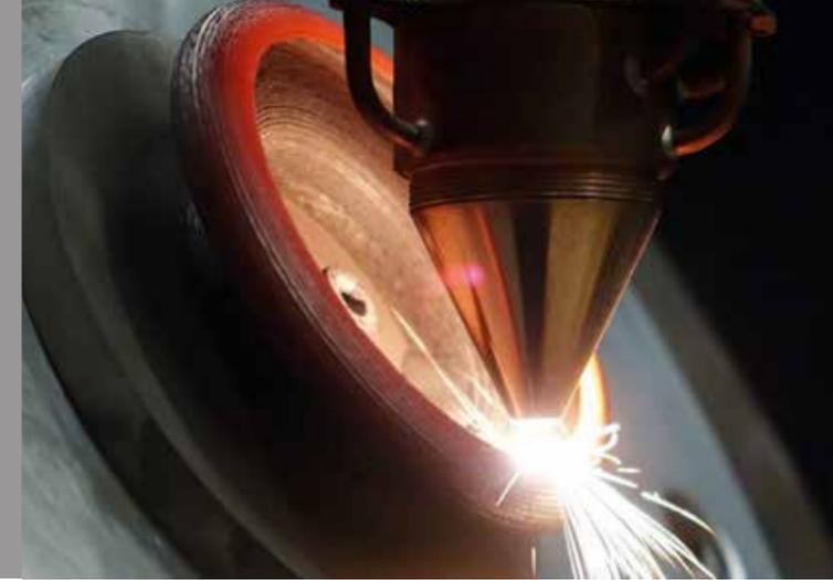
Roboterbasierte Additive Fertigung mit Laser Material Deposition.
