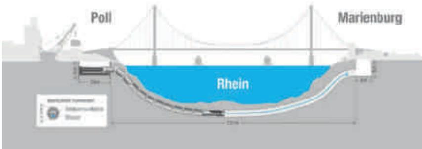
**Bild 5.2:** Der Trinkwasserdüker verläuft auf einer Länge von 725 Metern unter dem Rhein zwischen den beiden Kölner Stadtteilen Poll und Marienburg. Neben einer Trinkwasserleitung DN700 werden noch vier Leerrohre für Telekommunikation in den Tunnel eingezogen.
