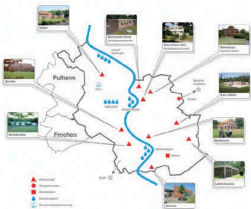
**Bild 5.1:** Das derzeitige Trinkwasserversorgungssystem der RheinEnergie: In acht Wasserwerken produziert das Unternehmen jährlich ca. 77 Mio. Kubikmeter Trinkwasser, welche über ein mehr als 3.000 Kilometer langes Leitungsnetz im Versorgungsgebiet verteilt werden. (Außerdem dargestellt sind zwei Betriebswasserwerke im Kölner Stadtteil Stammheim.)
