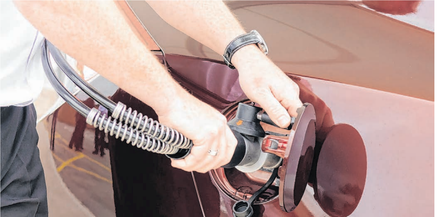
Rund drei Minuten dauert es, bis ein Wasserstofftank vollständig gefüllt ist.
