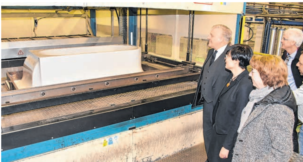
Aus einer 230 Grad heißen Acrylplatte ist eine Badewanne entstanden. Bis sie ausgeliefert werden kann, ist noch viel Handarbeit erforderlich.
