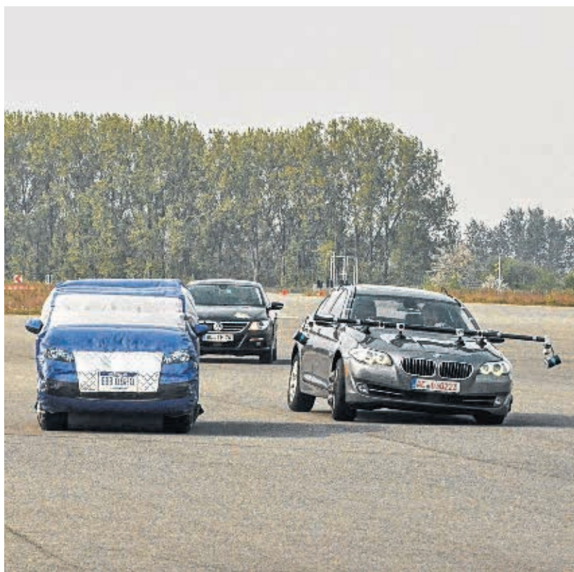
Versuch macht klug: Ein Testwagen mit Messvorrichtung umkurvt ein weißes Hindernis.
