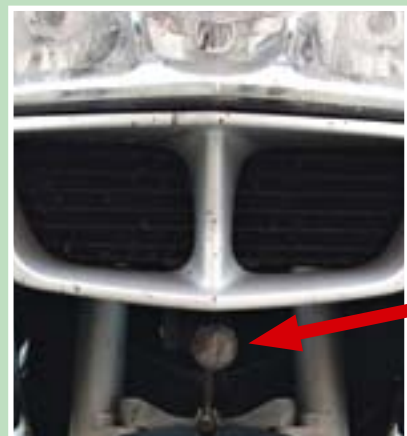
Unbestechlich: Das Kameraauge im Frontbereich des ProVida-Krades.
