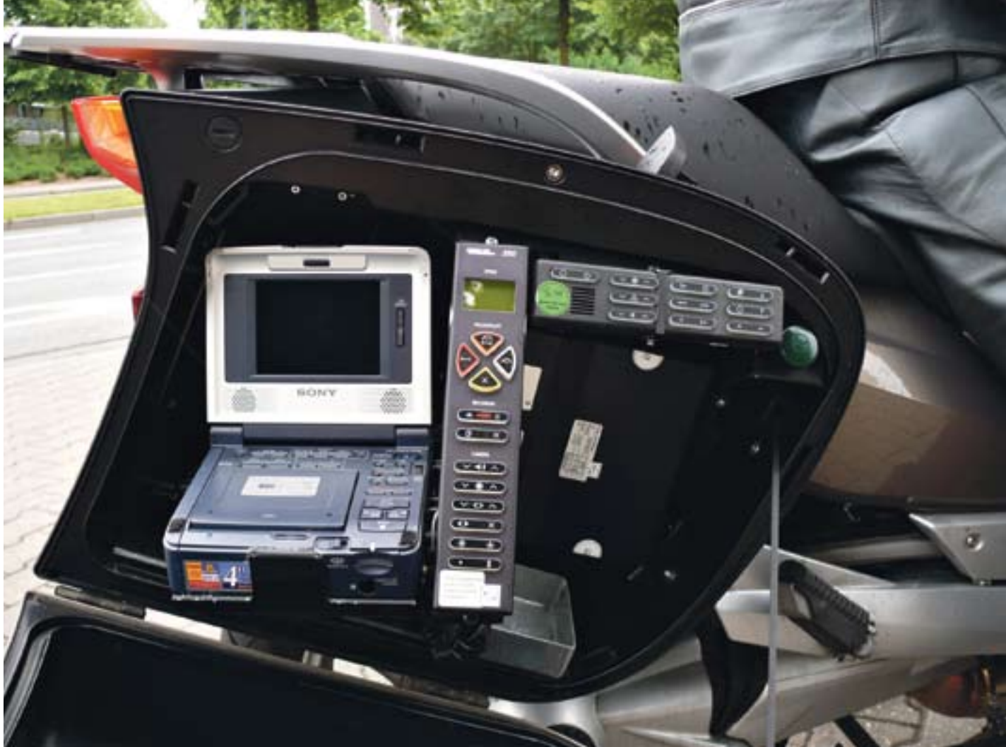
Aufzeichnungsanlage und Monitor befinden sich im Koffer: digitale Technik für mehr Sicherheit auf unseren Straßen.
