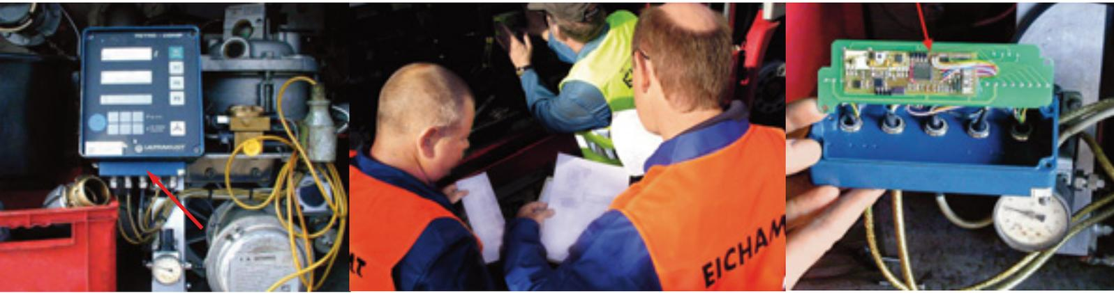
Ein funkgesteuerter Impulsgenerator war unter der Anschlussplatine im Klemmkasten des Anzeigengerätes eingebaut. Mit seiner Hilfe konnte man beliebige Mengen zur Anzeige bringen. Da der Klemmkasten nicht für eine eichamtliche Sicherung vorgesehen war, brauchten für den Eingriff keine Stempelstellen verletzt werden. Diese Manipulationsmöglichkeit wurde der Physikalisch Technischen Bundesanstalt gemeldet, die daraufhin die Bauartzulassung umgehend geändert hat.
