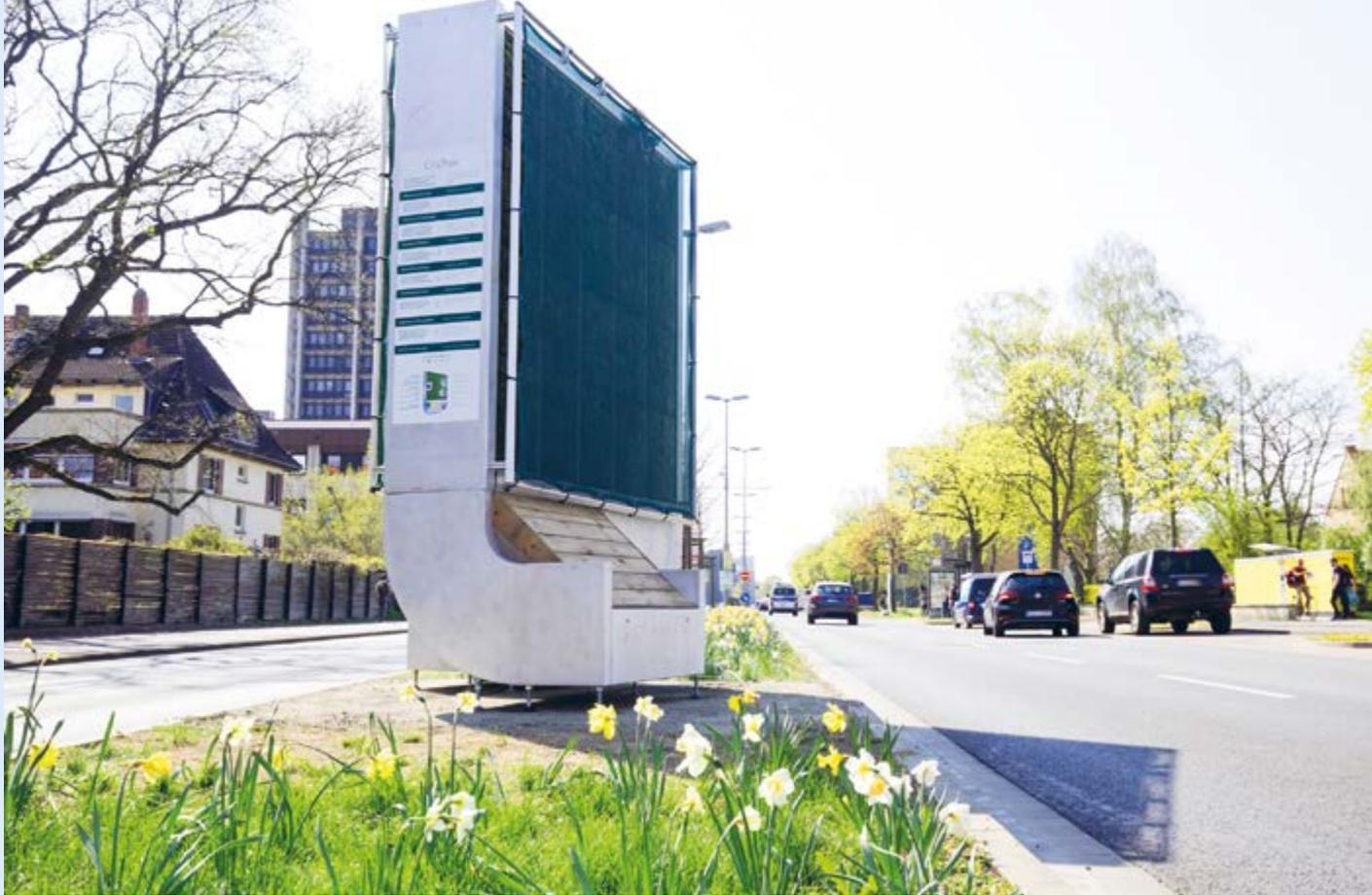
wird mittels Luv-/Lee-Messungen erhoben. Die Messinstrumente sind in den „CityTrees“ verbaut, und die Rohdaten werden der Universität zur Auswertung zur Verfügung gestellt.
