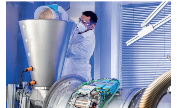
Einschütten des Zementrohmehls in einen sogenannten Schneckenförderer, der das Schüttgut nach dem Prinzip einer Schraube staubfrei weiterbefördert
