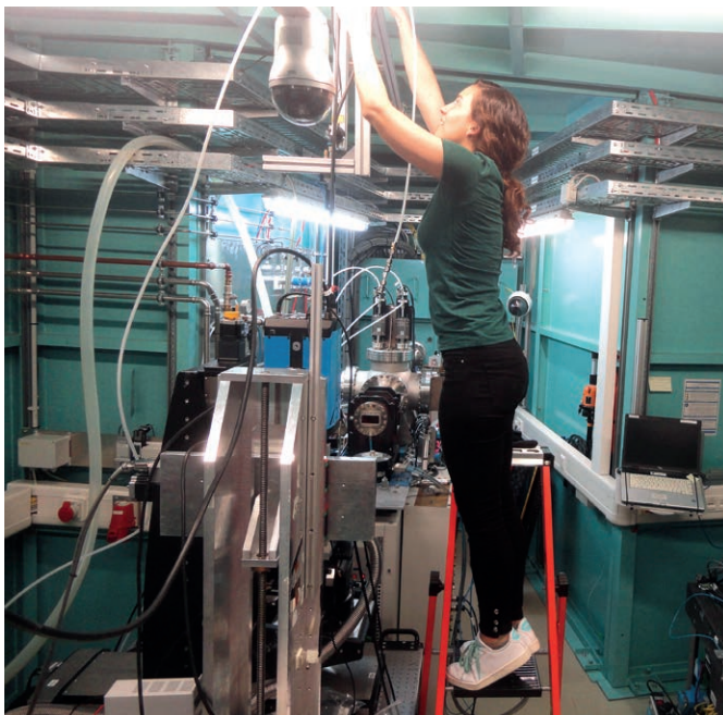
Postdoktorandin Dr. Işıl Şakraker Özmen beim Installieren des Röntgen-Ofens am Teilchenbeschleuniger des Karlsruher Instituts für Technologie (KIT)
