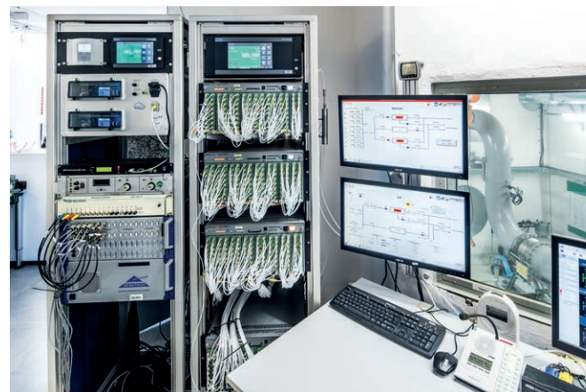
Hunderte Sensoren liefern Daten an das Messsystem des ICD-Prüfstands
