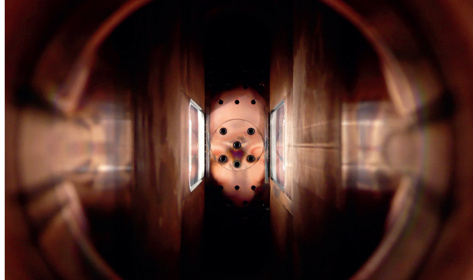
Blick durch die Düse auf die Einspritzelemente der experimentellen Brennkammer „H“; rechts und links davon die Fenster für den optischen Zugang
