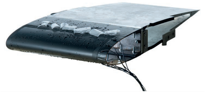
Die elektrische Heizung bringt das Eis auf der Vorderkante des Flügelmodells zum Schmelzen
