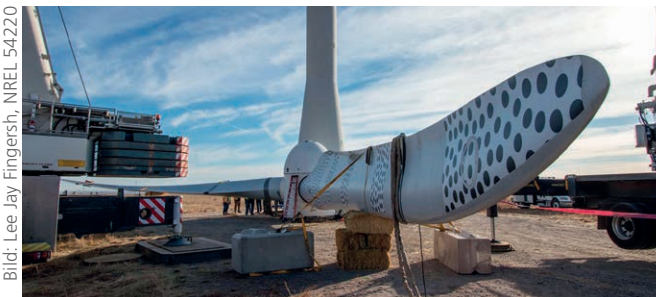
Die Rotorblätter passen sich den Wetterverhältnissen an, indem sie sich bei stärkerer Luftbewegung verwinden und dem Wind somit weniger Angriffsfläche bieten
