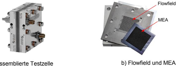
**Abb. 31: Testzelle für Experimente**
