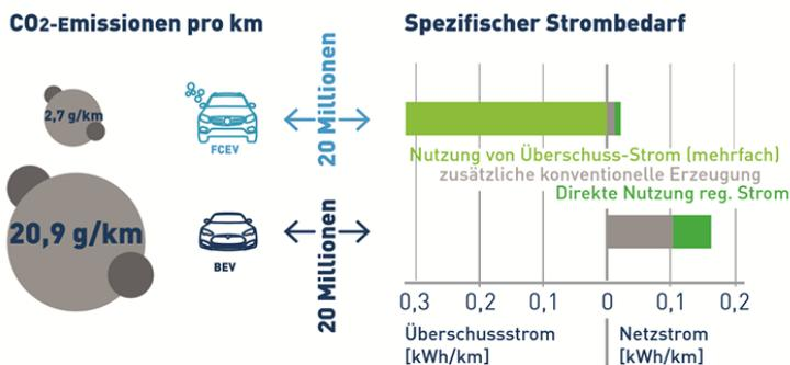
**Abb. 83: Vergleich der Kilometer abhängigen CO<sub>2</sub>-Emissionen und Strombedarfe bei 20 Millionen Fahrzeugen.**
