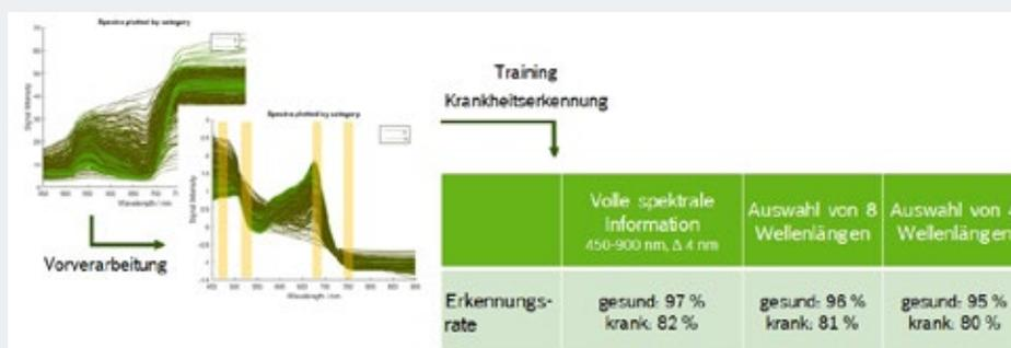
Abbildung 2: Erste Ergebnisse mit dem Punktspektrometer auf Basis von Gewächshaus- und Felddaten.
