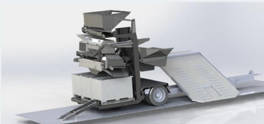
Abbildung 1: CAD-Konstruktion des Anhängerprototyps mit nachgelagerter, kardanisch aufgehängener Abbeermaschine und mechanischer Sortierung.
