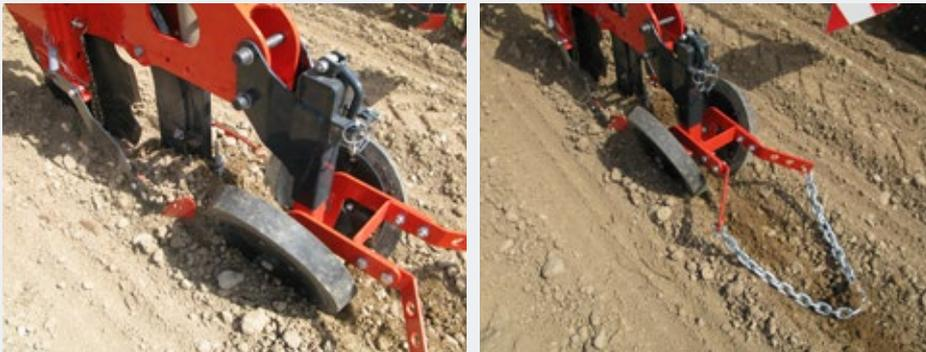
Abbildung 5: Optimierte Schareinheit für 2018 mit seitlichen Zustreifblechen am Düngerkanal (links) und Kette zur finalen Furchenglättung (rechts).
