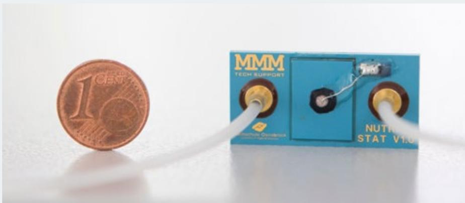
Abbildung 1: soil2data-Sensor mit ionensensitiven Feldeffekttransistoren (ISFETs) zur Messung von Bodennährstoffen.
