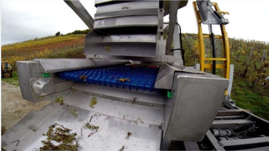
Abbildung 2: Abtransport von traubeneigenen Verunreinigungen direkt in den Weinberg.
