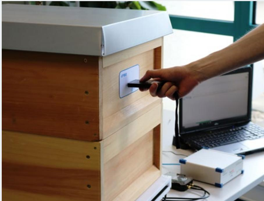
Abbildung 3: Kabellose Temperaturbestimmung innerhalb der Beute.
