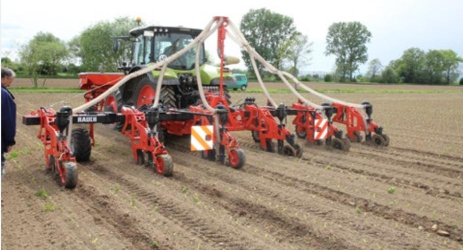
Abbildung 4: Depotdüngemaschine mit verschiedenen Andruckrollen-Varianten im Einsatz zur Maisdüngung im Frühjahr 2017 in Freiburg.
