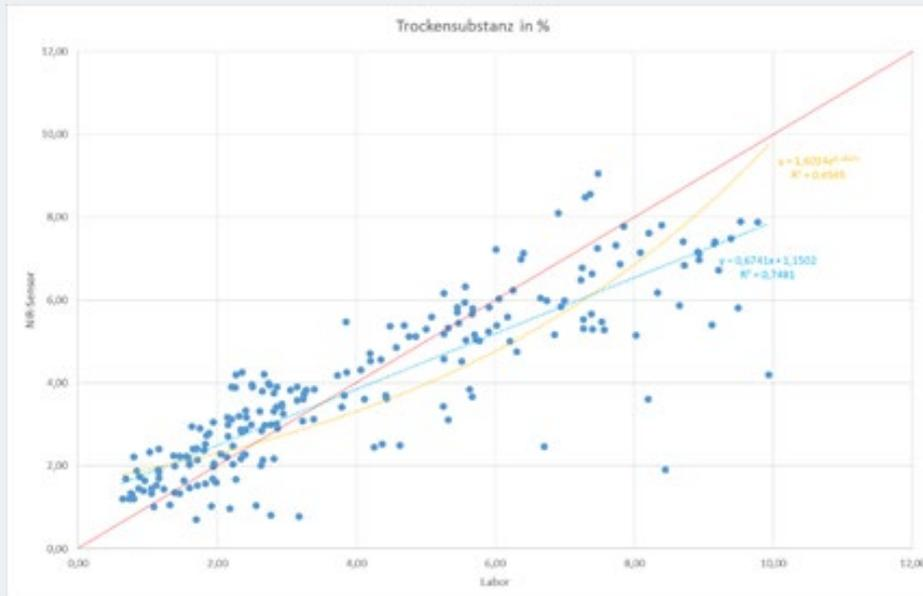
Abbildung 1: Korrelation von Sensor und nasschemischer Analyse für den Parameter Trockensubstanz.
