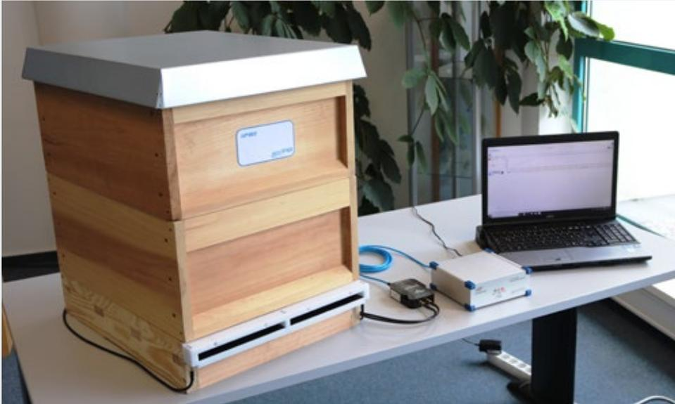
Abbildung 4: Darstellung eines Gesamtsystems zur Bienenidentifizierung und -erfassung.
