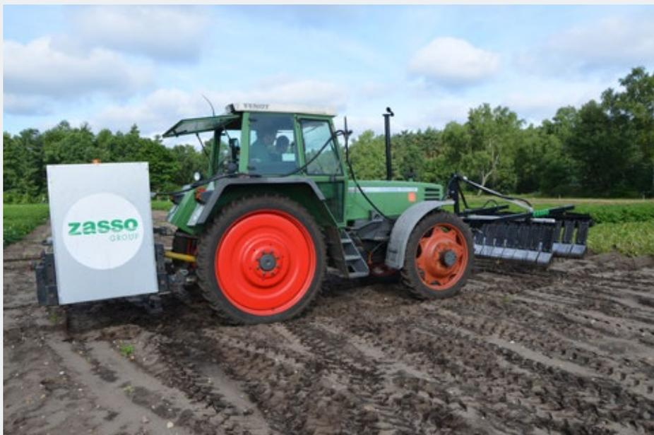
Abbildung 1: Krautminderungsgerät mit Applikatoren in Front- sowie Einheit aus Generator und Transformator im Heckanbau (bis 10.000 V, bis 100 A, Wechsel- oder Gleichstrom).
