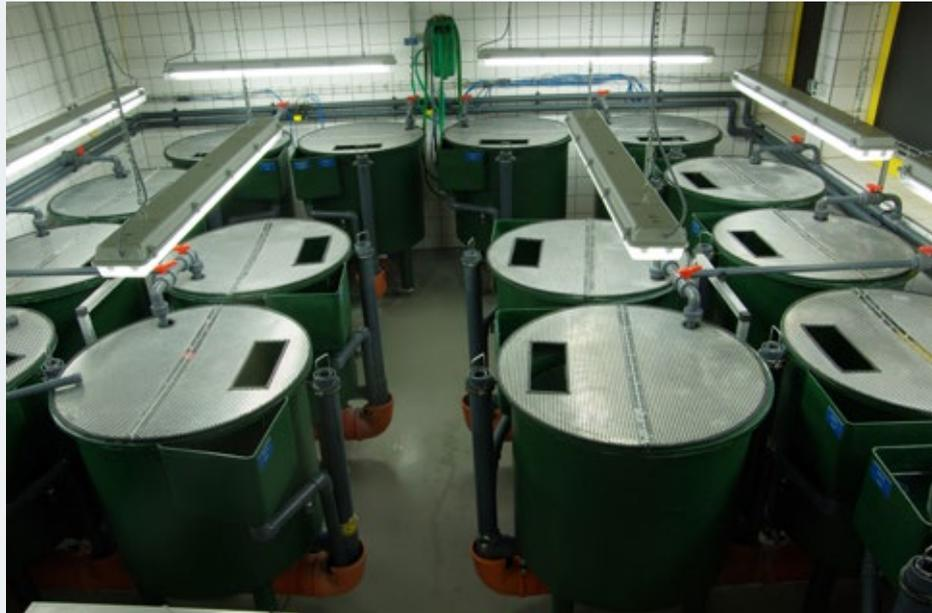
Abbildung 2: Versuchskreislaufanlage der Fischereiforschungsstelle Baden-Württemberg.
