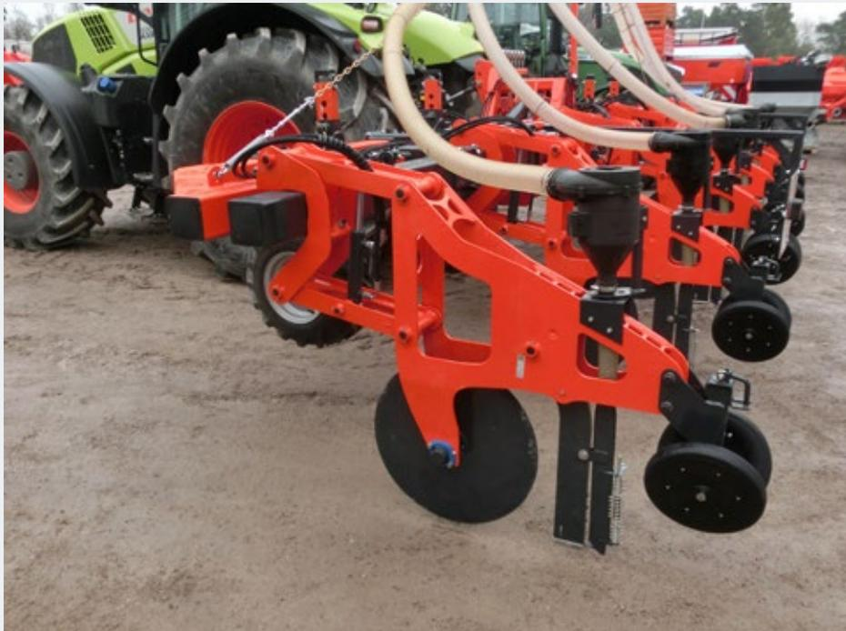
Abbildung 3: Injektionsschar Stand 2017 mit Schneidscheibe, Düngerkanal und V-Andruckrollen.
