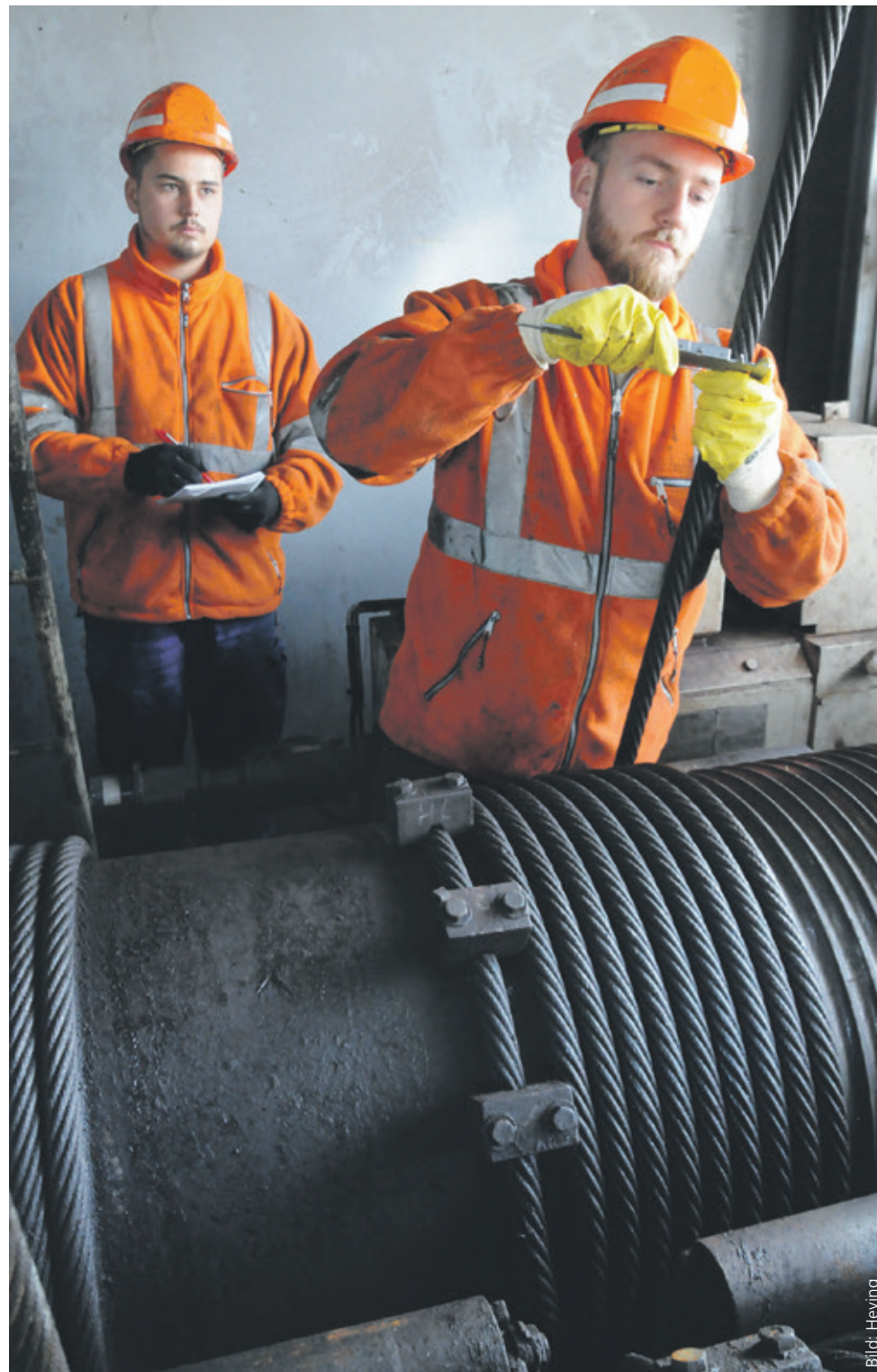
Philip Schaak (r.) überprüft ein Stahlseil, Daniel Arnold notiert die Ergebnisse.
