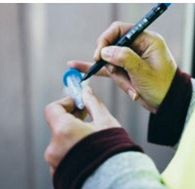
C-BORD: Vorbereitung eines Wischtests an einer Frachtcontainertür, um Spuren von Drogen oder Explosivstoffen nachzuweisen (oben)
