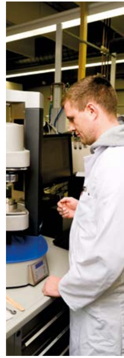
Jan Koepernik arbeitet als wissenschaftliche Hilfskraft im Forschungsprojekt MOTTSALE. Am Rheometer überprüft er die Klebeeigenschaft von Wirkstoffpflastern.
