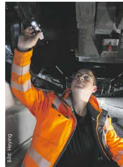
Auch eine Inspektion des Unterbodens der Lokomotive ist notwendig.
