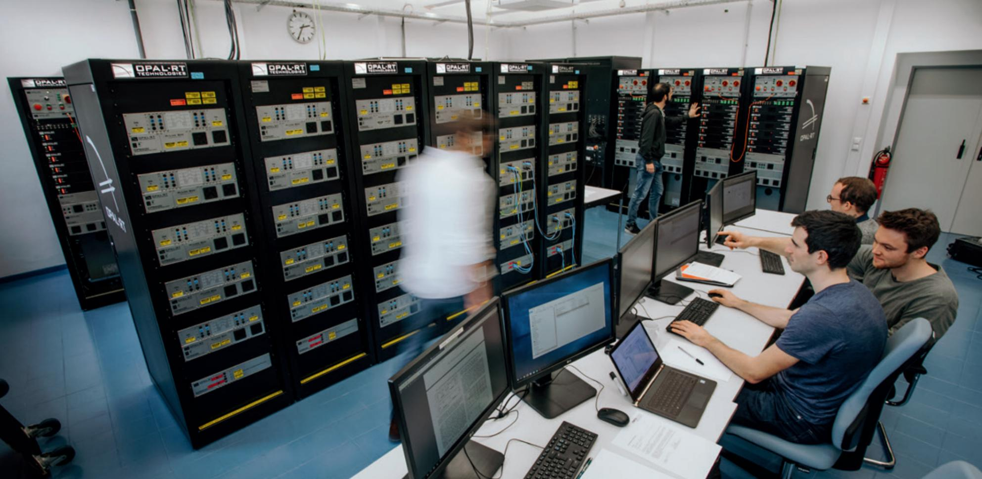
MMC Test Bench – Labordemonstrator zur Untersuchung von HGÜ-Systemen
