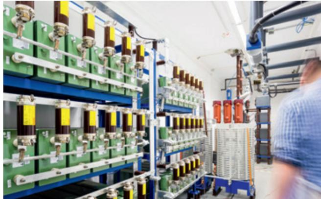
Weil-Dobke-Prüfkreis zur synthetischen Leistungsschalterprüfung
