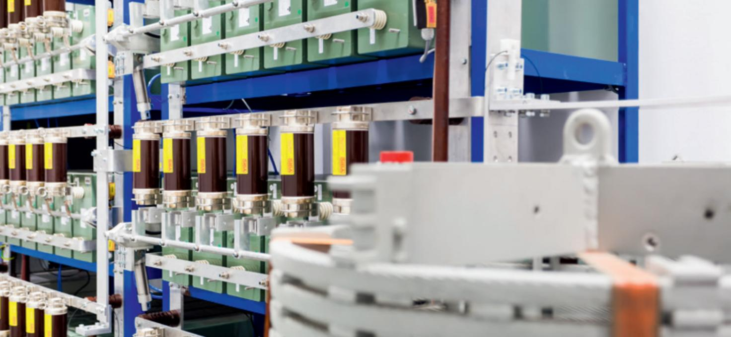
Weil-Dobke-Prüfkreis zur synthetischen Leistungsschalterprüfung
