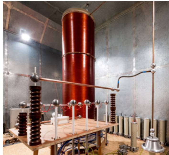
Abbildung 1: Prüfstand zur Ermittlung der Durchschlagspannung bei sinusförmigen Spannungen
