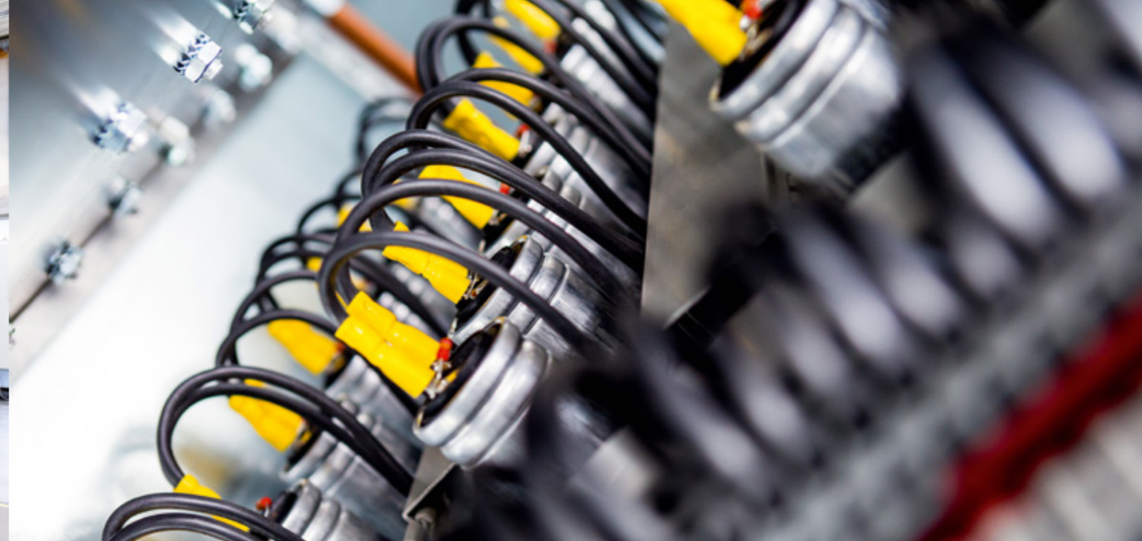
Abbildung 2: RLC-Lasteinheit zur Ausregelung der Wirk- und Blindleistungsbilanz und Abstimmung der Resonanzfrequenz
