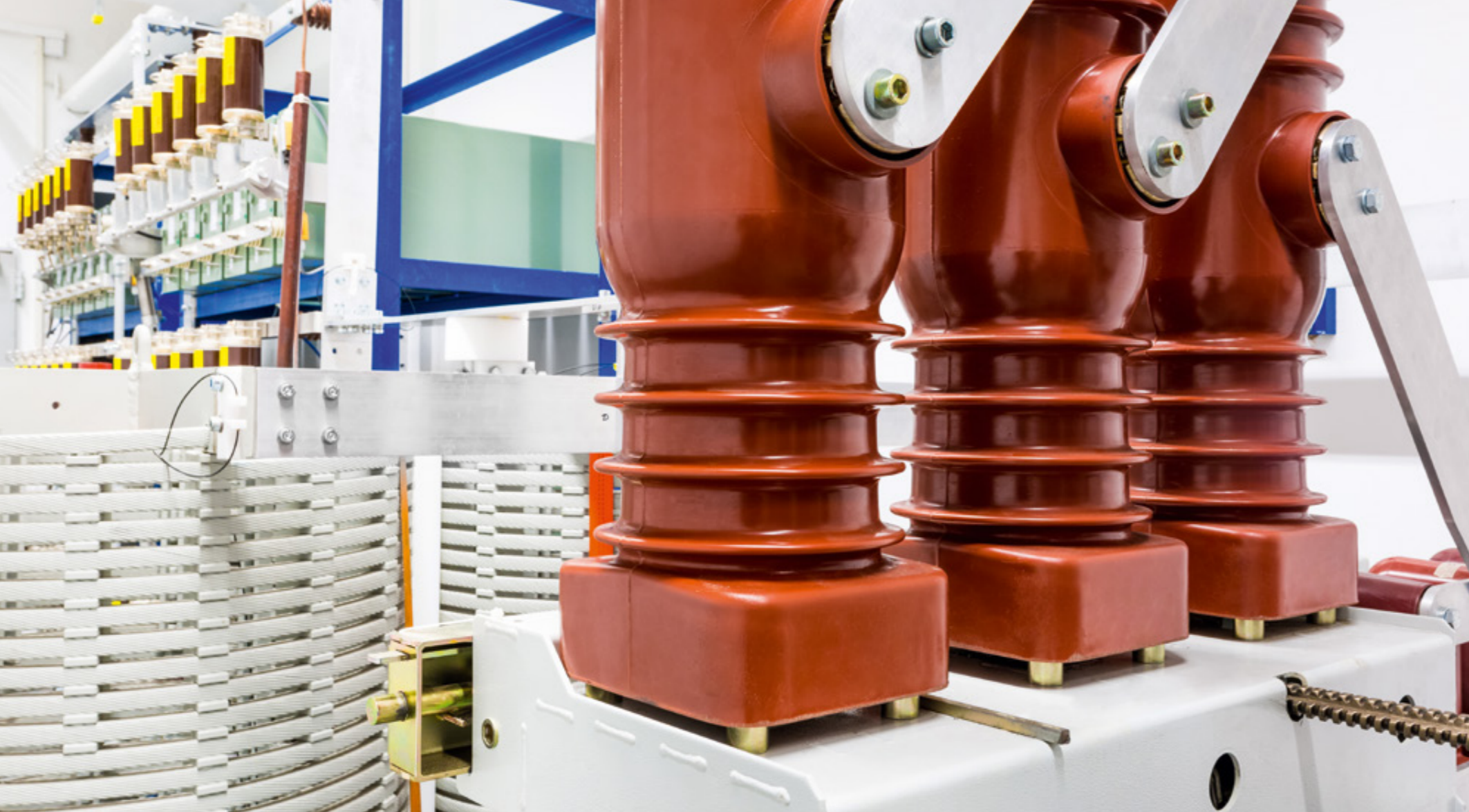
Synthetischer Prüfkreis zur Leistungsschalterprüfung
