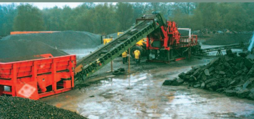
Zerkleinerung von Asphalttschollen im Brecher
