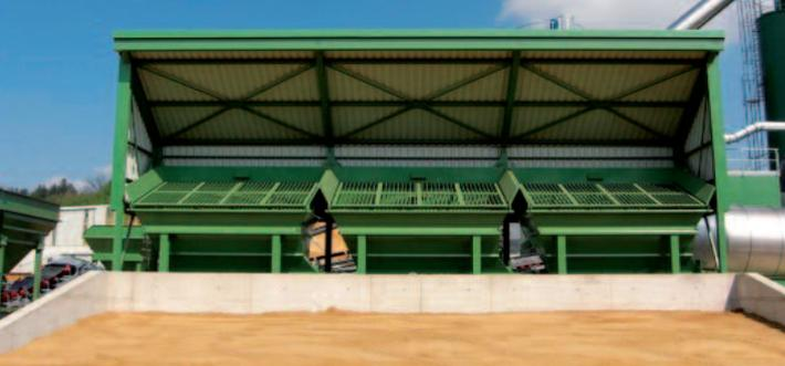
*Drei getrennte Doseure für die Zugabe von Asphaltgranulat bei der Herstellung von Asphaltmischgut für Asphalttragschichten einerseits und Asphaltbinder- und Asphaltdeckschichten andererseits*
