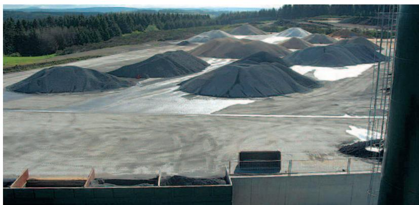
*Die getrennte Gewinnung und Lagerung des Asphaltgranulates ist Voraussetzung für eine hochwertige Verwendung*
