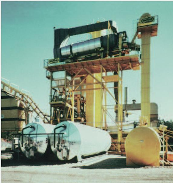
*Paralleltrommel zur schonenden Trocknung und Erwärmung des Asphaltgranulates – hoch gesetzt, damit das erwärmte (und klebende) Asphaltgranulat keine weiteren Fördergeräte verkleben oder zusetzen kann.*
