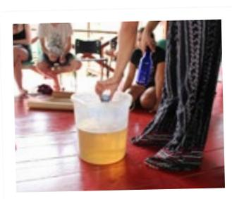
Vier Gramm Pulver reichen zur Reinigung von 10 Liter Wasser. Das Ganze wird einige Minuten gerührt.
