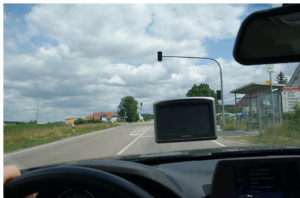
Sichtverdeckung in relevanten Bereichen durch ungünstig montiertes mobiles Endgerät
