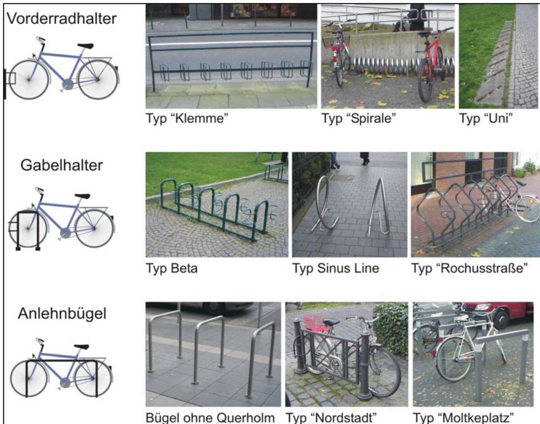
**Abb. 2.11:** Beispiele für eingesetzte Abstellanlagenmodelle in Bonn [eigene Darstellung]
