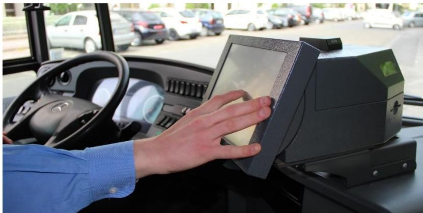
Abbildung 39: ITCS-Bordrechner am Fahrerarbeitsplatz in einem Linienbus
