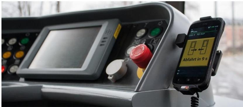
Abbildung 42: Smartphone-Anwendung „Computer-Optimised Speed control for Energy-efficient Light-rails“ der DVB (Pressefoto DVB AG 2017)
