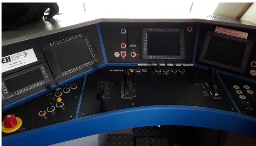
Abbildung 74: Triebfahrzeug-Führerraum einer Drehstromlokomotive der BR 193 (Siemens Vectron)
