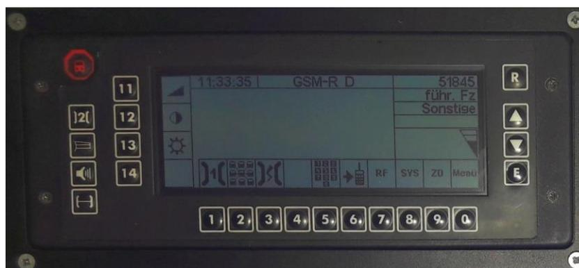
Abbildung 30: GSM-R Zugfunkgerät
