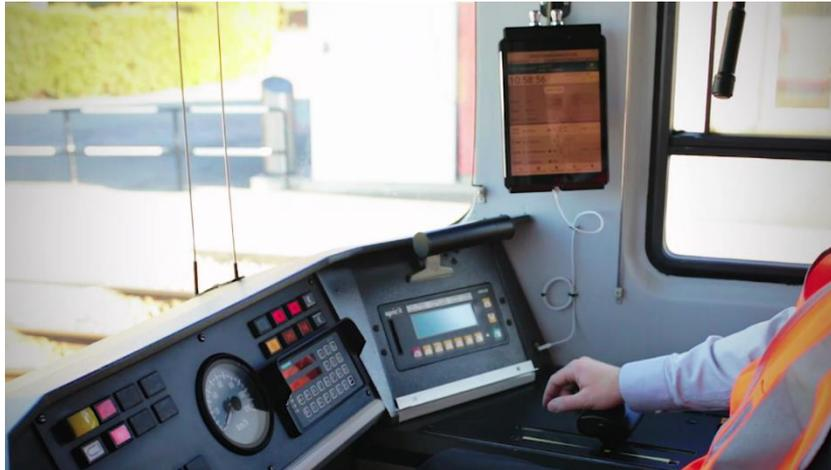
Abbildung 20: Tablet-Anwendung IVU.pad in einem Schienenfahrzeug
