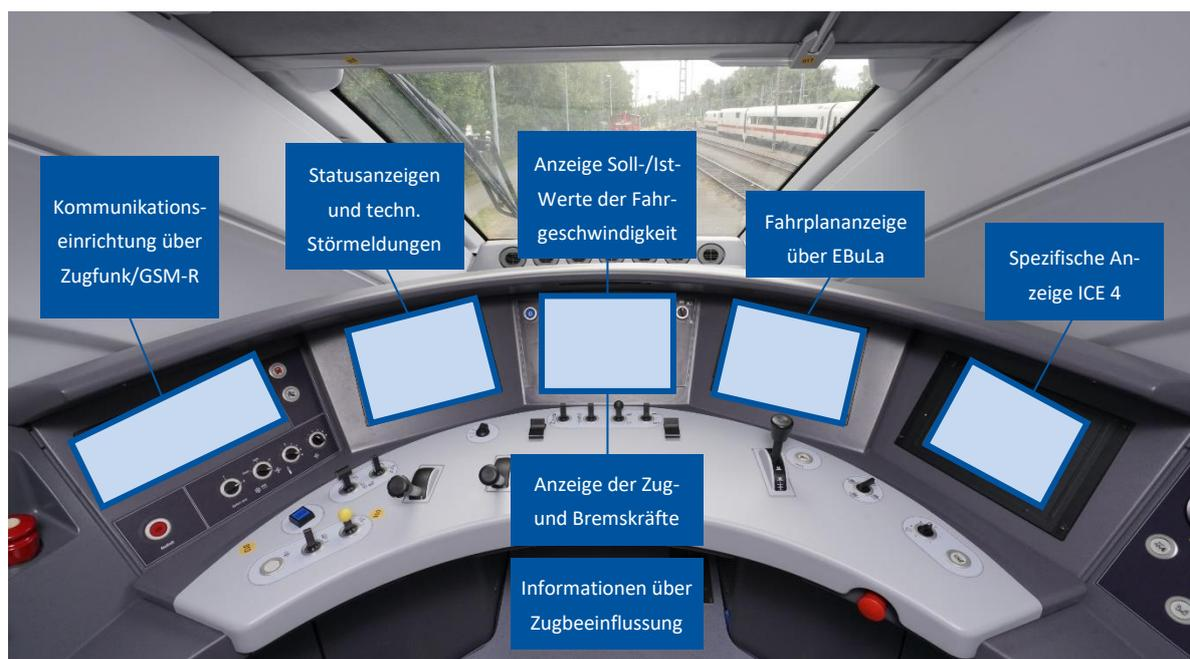
Abbildung 24: Führerraumanzeigen und Informationen im Tfz am Beispiel des ICE 4 (BR 412)
