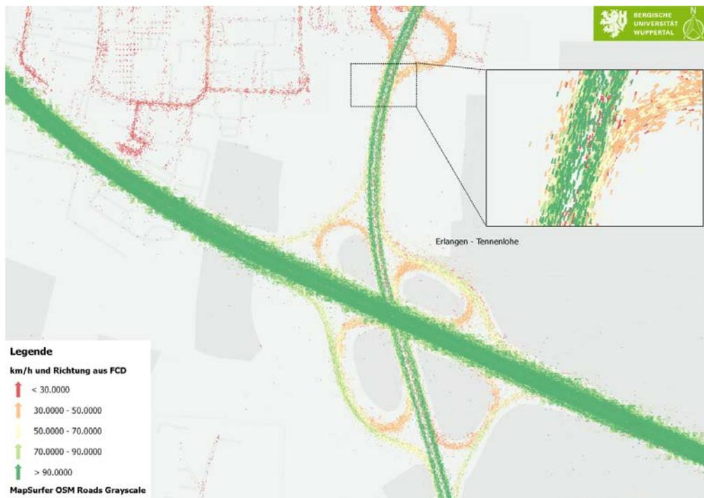
Abbildung 5.4: FCD-Messwerte im Nahbereich der AS Erlangen–Tennenlohe (BAB 3)
