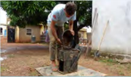
Mit der Ziegelpresse werden die Steine nicht mehr aufwendig in Form geklopft, sondern effektiv gepresst.
