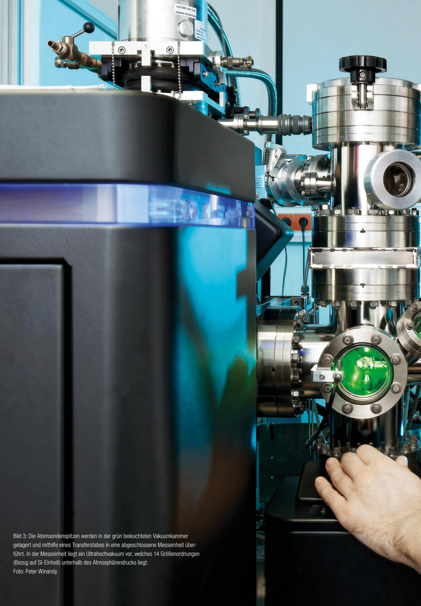
Bild 3: Die Atomsondenspitzen werden in der grün beleuchteten Vakuumkammer gelagert und mithilfe eines Transferstabes in eine abgeschlossene Messeinheit überführt. In der Messeinheit liegt ein Ultrahochvakuum vor, welches 14 Größenordnungen (Bezug auf SI-Einheit) unterhalb des Atmosphärendrucks liegt.
