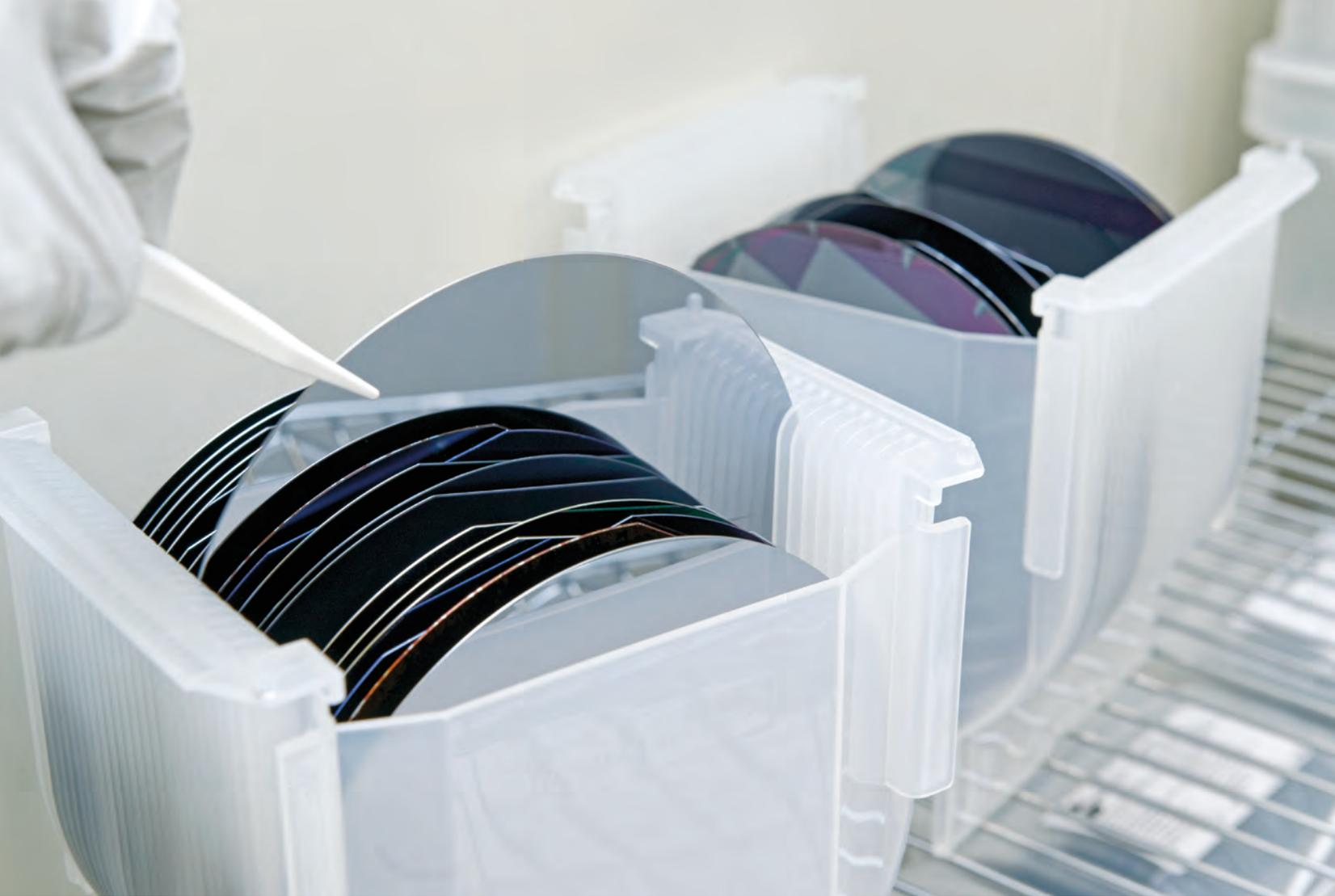
Bild 2: Kassetten mit Silizium-Wafern für die Herstellung von 2D-materialbasierten elektronischen Bauelementen im Reinraum der AMO GmbH
