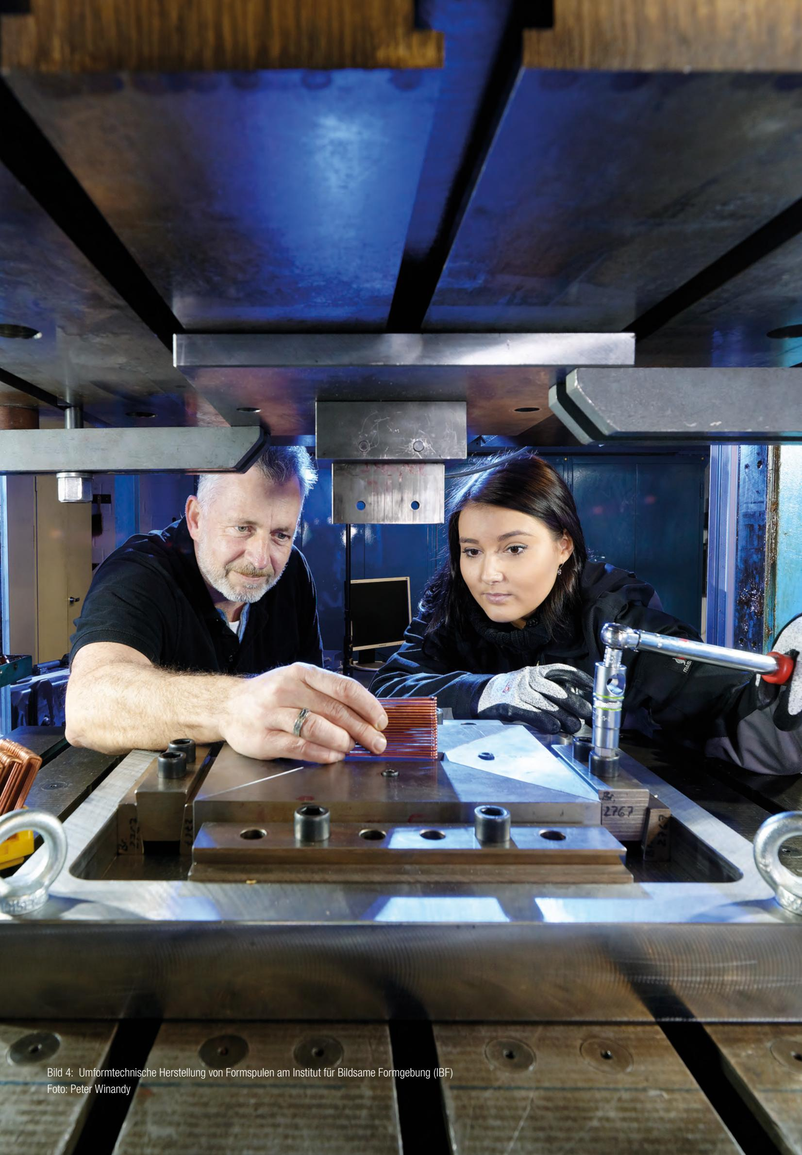
Bild 4: Umformtechnische Herstellung von Formspulen am Institut für Bildsame Formgebung (IBF)
