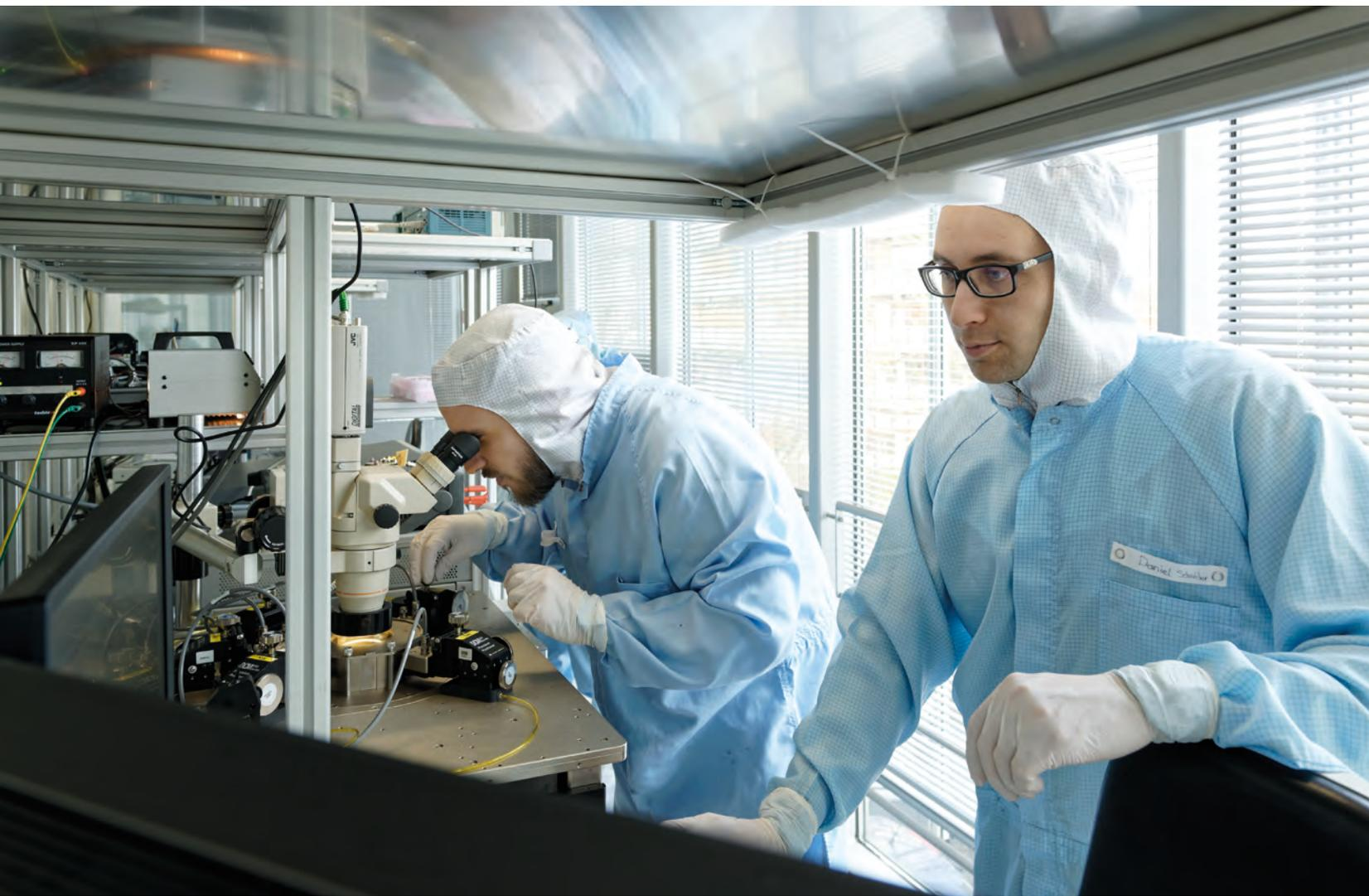
Bild 8: 2D-Bauelemente werden im Reinraum der AMO GmbH elektrisch charakterisiert.
