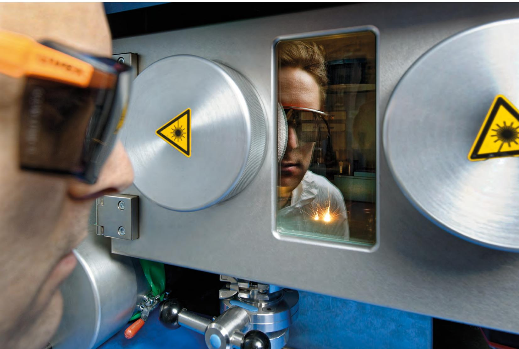
Bild 2: Blick in den Bauraum: Mit einem Laserstrahl werden komplexe Bauteile aus Metallpulver additiv aufgebaut.
