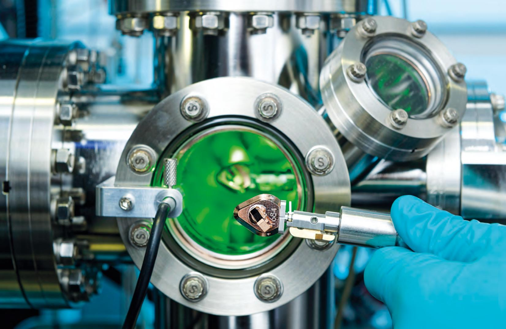
Bild 6: Blick auf einen Silizium-Probenhalter, welcher mittels einer Kupfer-Feder fixiert ist. Das Silizium-Plättchen bietet Platz für bis zu 36 Atomsondenspitzen.
