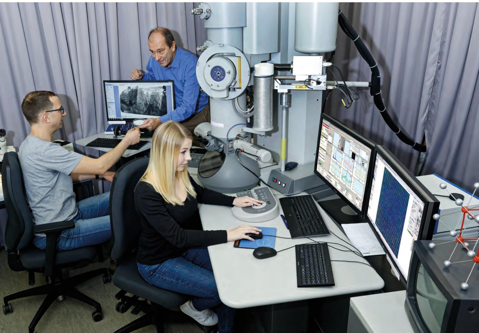
Bild 1: Untersuchung eines modernen Werkstoffs in einem Transmissionselektronenmikroskop am Gemeinschaftslabor für Elektronenmikroskopie (GFE).
