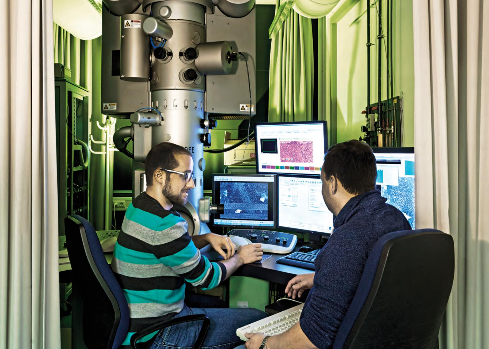
Bild 8: Das Transmissionselektronenmikroskop Zeiss LIBRA am Gemeinschaftslabor für Elektronenmikroskopie erlaubt aufgrund seiner besonderen Ausstattung selbst die Untersuchung von Probenmaterial in einer flüssigen Umgebung.
