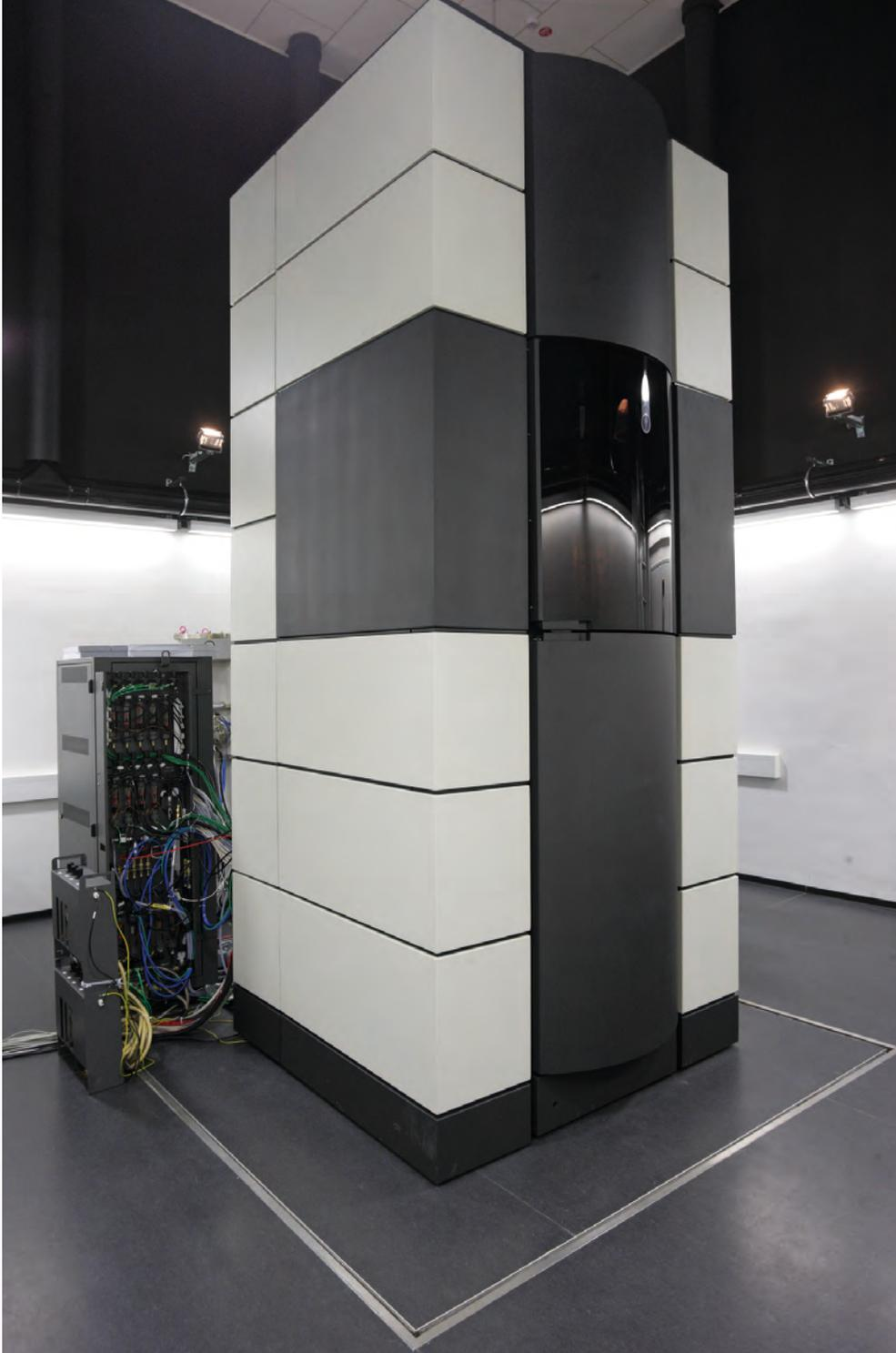
Bild 2: PICO ist das zweite Transmissionselektronenmikroskop weltweit mit einem Korrektor für die sphärische Aberration.
