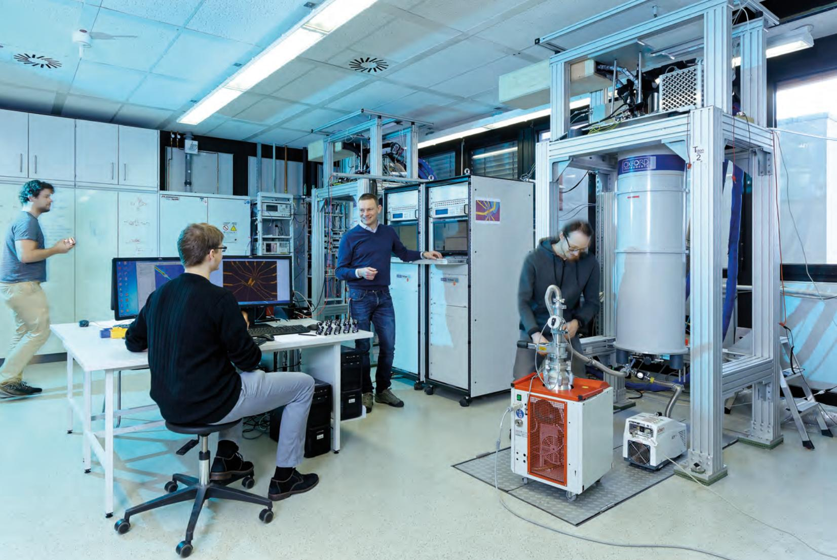
Bild 1: Tieftemperatur-Labor am 2. Physikalischen Institut. Mit den experimentellen Aufbauten lassen sich physikalische Eigenschaften von 2D-Materialien bei Temperaturen von 10 mK bis 50 K und Magnetfeldern bis zu 14 Tesla untersuchen.
