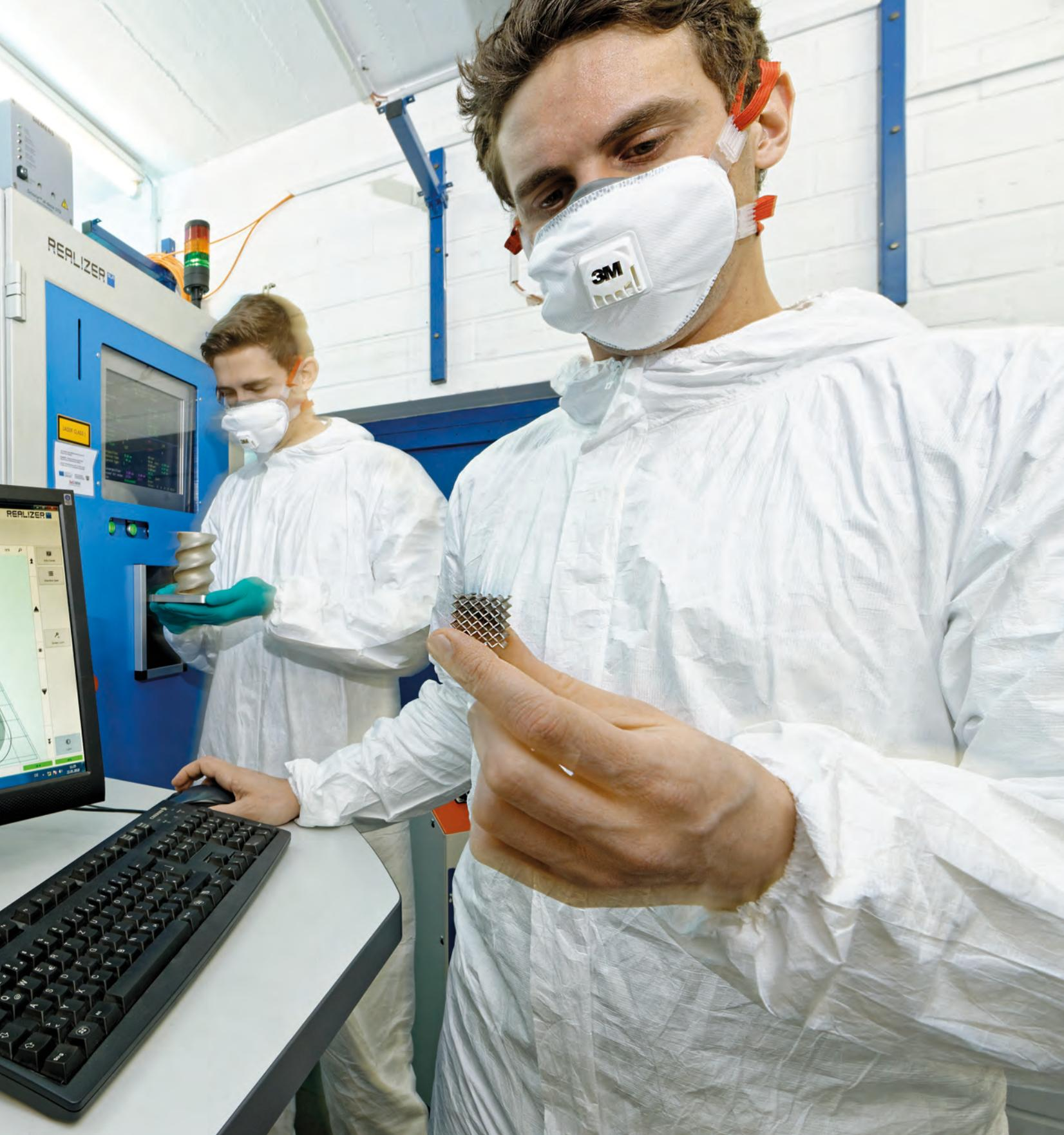
Bild 7: Am Computer werden Bauteile und Proben entworfen und für die additive Fertigung aufbereitet. Filigrane oder komplexe Strukturen werden aus der Software als Bauteil-
