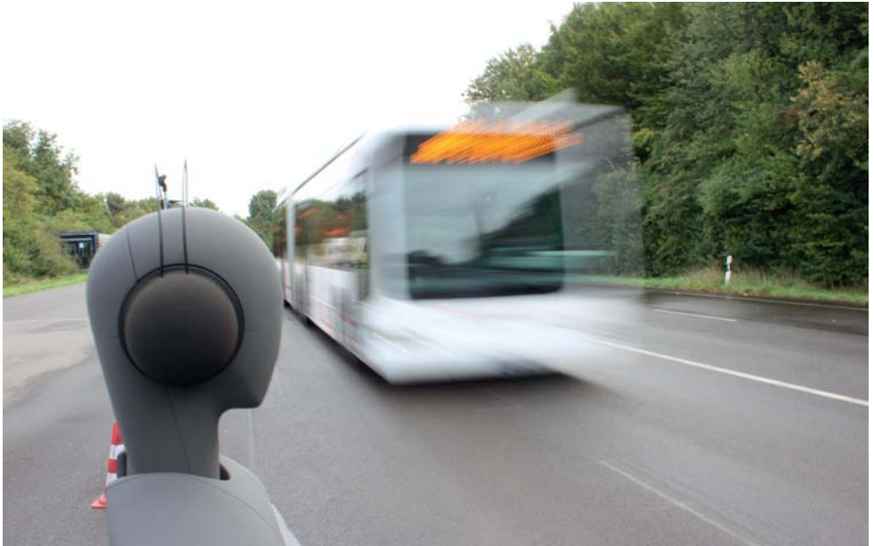
Geräuschmessungen mit einem Kunstkopf
