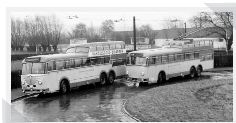
Diesel- und Obus-Anderthalbdecker mit Ludwig-Aufbauten und Fahrgestellen von Büssing (links) und Henschel (rechts)
