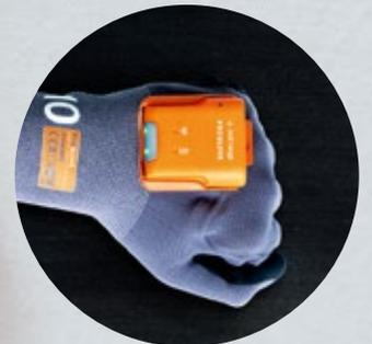
Der Handschuh mit integriertem Scanner von ProGlove sorgt in den Bereichen Fertigung, Verpackung oder Kommissionierung für mehr Effizienz und Flexibilität.
