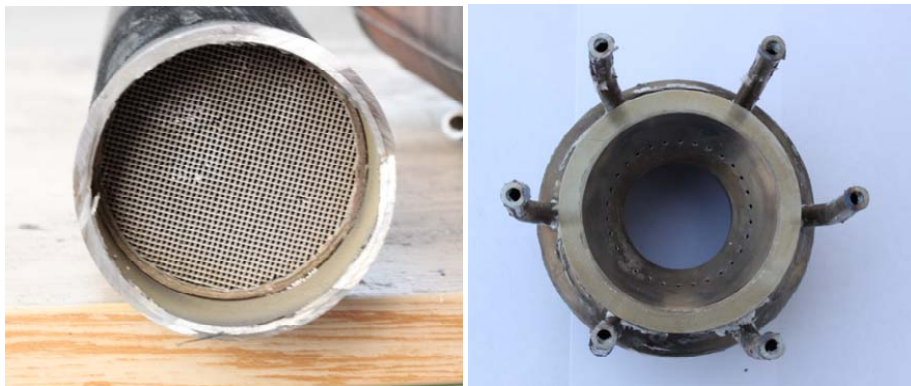
Abb. 117: Post-Mortem Aufnahmen des Reformierungskatalysators und einem Bauelement der Mischkammer zur Luftdosierung
