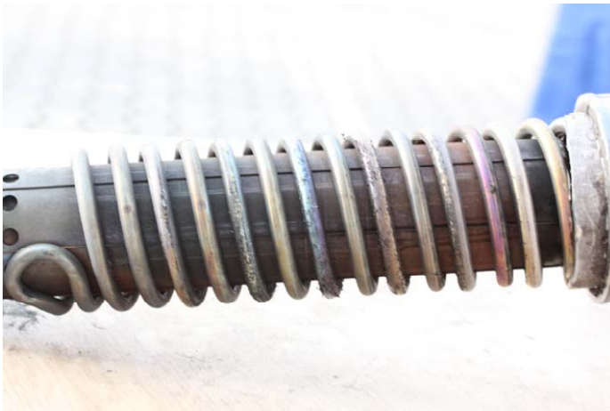
Abb. 129: Post-Mortem Aufnahmen der inneren Einbaurohre zur Abtrennung der Wärmeaustauscherkammern
