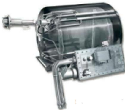
Abbildung 5-72: Kryogentank des BMW Hydrogen 7 [139]
