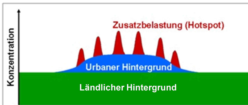
Bild 5.5 Schema der Zusammensetzung der städtischen Gesamtbelastung nach /Lenschow et al. 2001/; Bildquelle: nach /UBA 2011/
