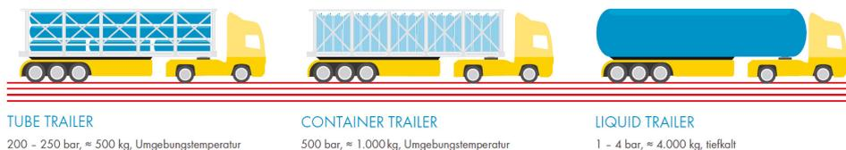
Abbildung 4: Unterschiedliche Technologien zum Transport von elementarem Wasserstoff mit einem LKW, angelehnt an [12].
