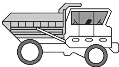
Muldenkipper mit Zweiweg-Sitz und -Steuerung
